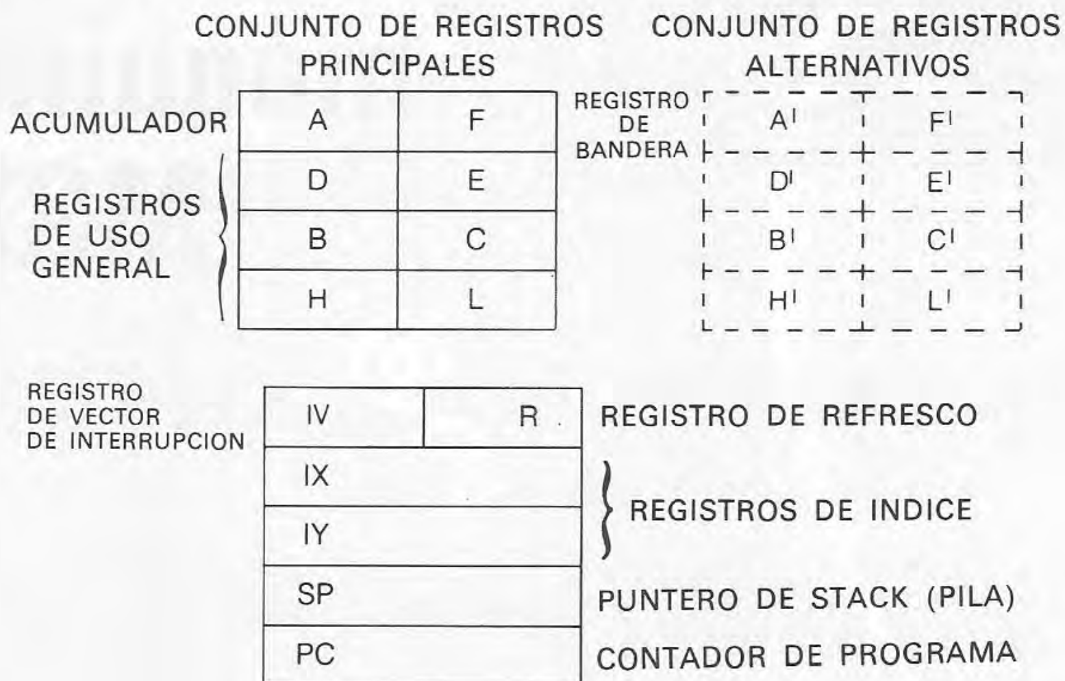
Figura 12.1.—Registros del microprocesador Z-80.
