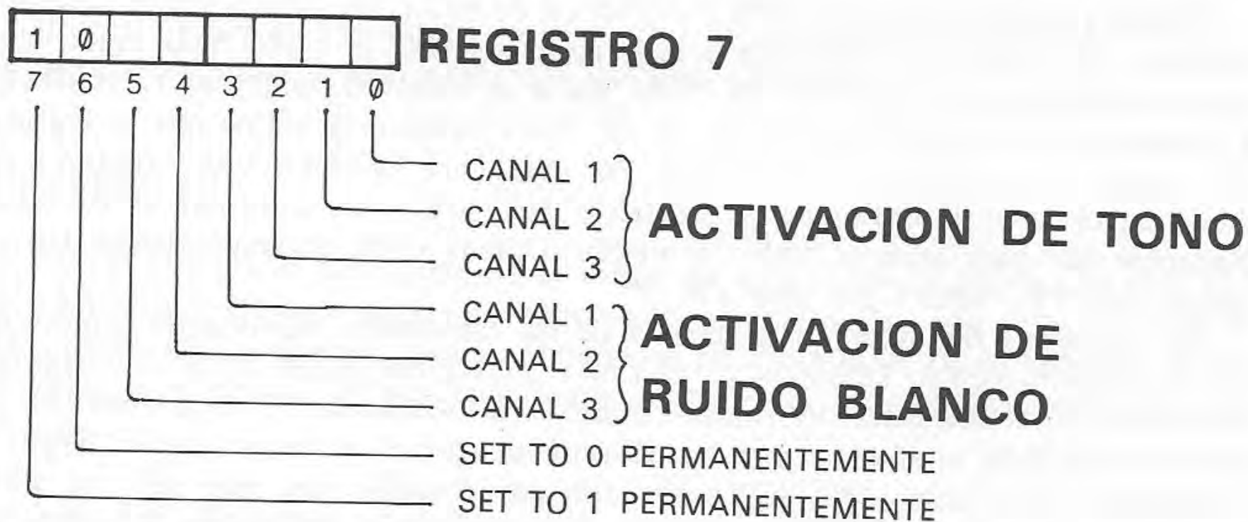
Figura 8.3. —Funciones de los bits en el registro 7, generador de sonido programable.
