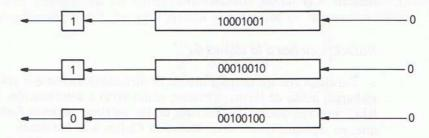
Hay dos tipos de operaciones de rotación o de desplazamiento según el sentido en el que se muevan los bits: si los bits se mueven hacia la izquierda, se llama de rotación o de desplazamiento a la izquierda; si es hacia la derecha, se llama de rotación o de desplazamiento a la derecha.
