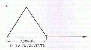
En este gráfico vemos un incremento gradual de la amplitud seguido por una disminución. A este tipo de sonido se llama ENVOLVENTE. En los ordenadores MSX hay ocho ENVOLVENTES diferentes. En otros ordenadores con generadores de sonido programables más sofisticados es posible construir las envolventes para lograr un sonido determinado.
