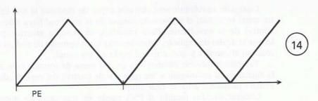
En todos estos ejemplos, PE es la abreviatura de Período de la Envolvente, que es una unidad de medida que indica el tiempo que tarda en ejecutarse un ciclo de la envolvente. Cambiando los valores de los registros 11 y 12, puedes variar este parámetro y, por tanto, variar la proporción del cambio de la amplitud bajo el control de la envolvente.
