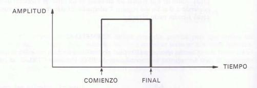
El volumen del tono va desde 0 hasta su valor máximo, donde permanece constante hasta que vuelve otra vez al 0. Si pudiéramos dibujar la amplitud de una nota, como en la figura siguiente, oiríamos un sonido bastante extraño.
