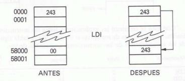
Después de ejecutarse la instrucción LDI, el par HL indicará la posición 0001 y el par de registros DE la posición 58001. Después de ejecutar las instrucciones LDI y LDD, y si el par de registros BC no es igual a 0, el flag P/V se activará. Por tanto, podemos usar dicho flag para saber si necesitamos repetir la instrucción o no.
