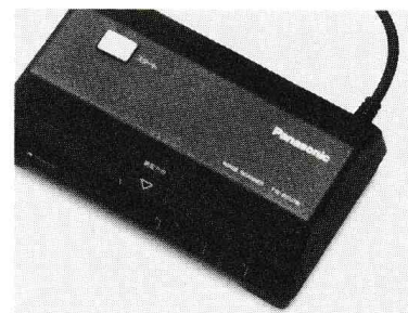
↑高価だけどスキャナを使えば一瞬にして原画を取り込むことができる。MSX用にはイメージスキャナというものがある(写真)
