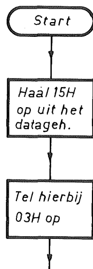
Fig. 2 Stroomdiagram van een optelling.
