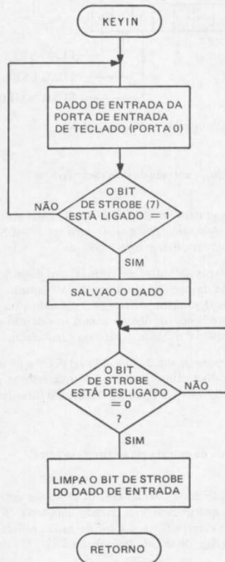
Figura 6.7 Fluxograma do módulo de entrada do teclado.
