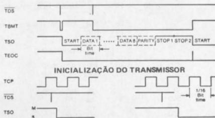
No início da transmissão de dados ou quando não se está transmitindo a 100% da utilização da linha, o bit de partida será colocado na linha TSO durante a transição de "1" para "0" do clock TCP, obedecendo a transição negativa de TDS.
