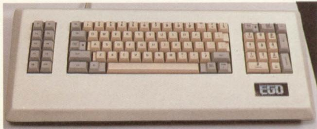
O teclado tem três partes: na central, as teclas alfanuméricas, com algumas teclas de controle; à esquerda, dez teclas programáveis; e à direita, o teclado numérico reduzido.
