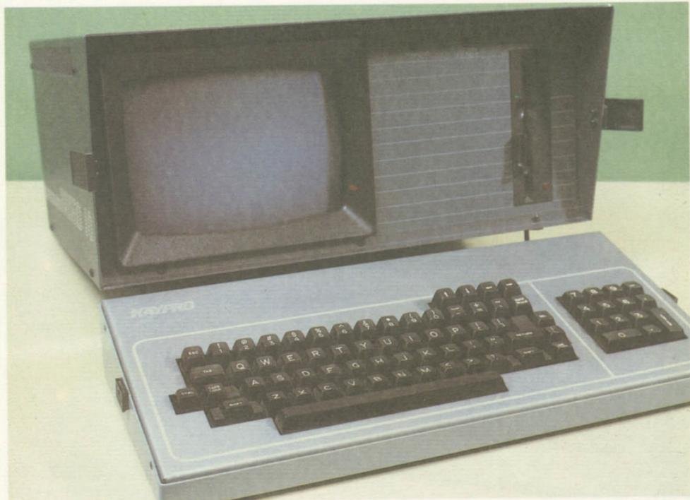
Alguns computadores portáteis baseados no microprocessador Z 80 são gerenciados por esse sistema operacional. O Kaypro da ilustração utiliza a variante CP/M 2.2.
