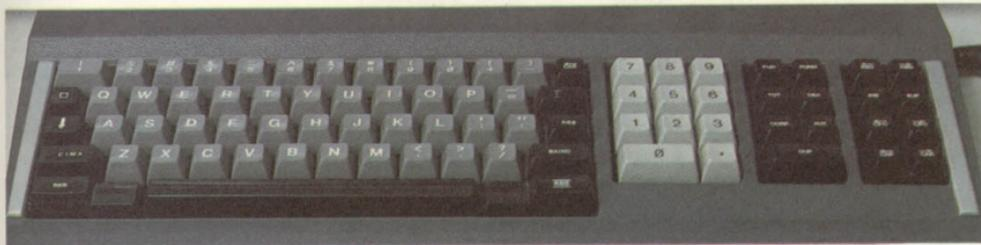
O teclado, eletromecânico, do tipo ASCII, tem três blocos: alfanumérico, numérico reduzido (com os dígitos de 0 a 9) e de funções. Do total de 88 teclas, 83 geram códigos; as outras definem o modo da operação.
