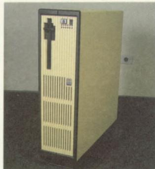
Até quatro unidades de disquete de 5 1/4 ou 8" e um disco Winchester de 5 a 16 Mbytes podem ser acondicionados no sistema como memória auxiliar.
