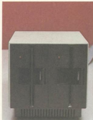
O SID 3300 utiliza discos flexíveis de 5 1/4" e o SID 3800, de 8". Ao contrário dos outros dois modelos, o SID 3900 baseia-se numa memória auxiliar de discos rígidos, de 10 Mbytes.
