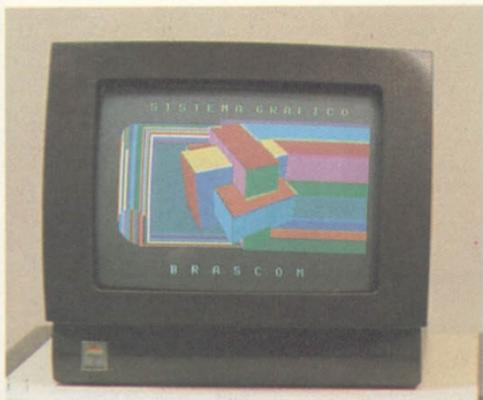
O vídeo gráfico opcional (para sistema BR 1000 monousuário) adiciona capacidade gráfica de média ou alta resolução, através de conexão com TV ou monitor em cores.
