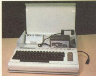
Para propiciar um aumento significativo da capacidade de memória, a Commodore criou um gabinete de ampliação, permitindo a conexão de vários módulos externos.
