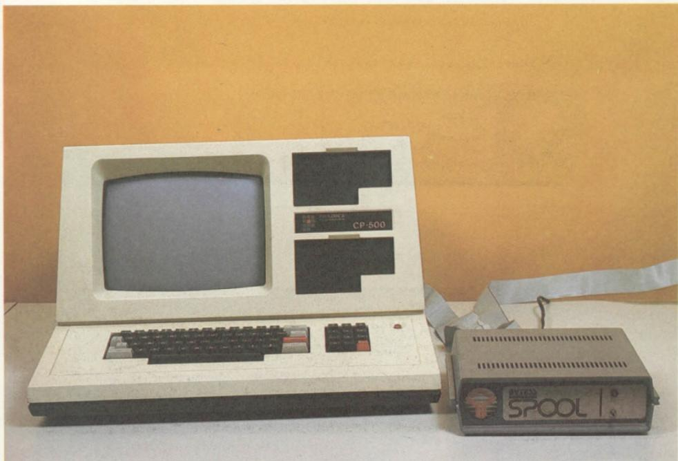
Memória auxiliar para impressora BYTESSPOOL, produzida pela Bytess/Claritron, conectada a um computador Prologica CP 500. Na foto vêem-se os cabos que fazem as interligações. Para cada tipo de equipamento são fornecidos cabos específicos, conforme indicação dos fabricantes.
