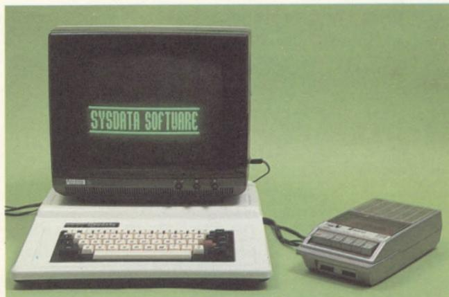
O microcomputador pessoal JR Sysdata pertence à linha dos compatíveis com o TRS 80, modelos I e III. Em sua configuração mínima, oferece 16 kbytes de RAM, e pode ser ligado a TV e gravador cassete.
