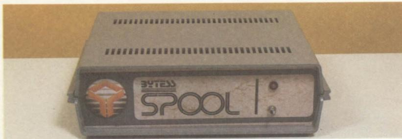
Vista frontal do BYTESSPOOL, com o interruptor de energia e o indicador de "ligado". A caixa é de plástico injetado, com ranhuras para ventilação.
