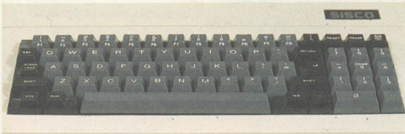
Além do teclado numérico reduzido, existem 12 teclas que podem ser programadas de acordo com o aplicativo. Algumas combinações de teclas possibilitam seu uso como terminal de um computador central.
