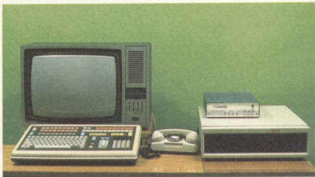
O armazenamento das informações armazenadas em memória de computador, no sistema Videotexto, é feito graças à conexão de um aparelho telefônico a um receptor de televisão doméstico. Para isso, usa-se um dispositivo dotado de teclado alfanumérico, por onde o usuário dá entrada a seus pedidos de informações.
