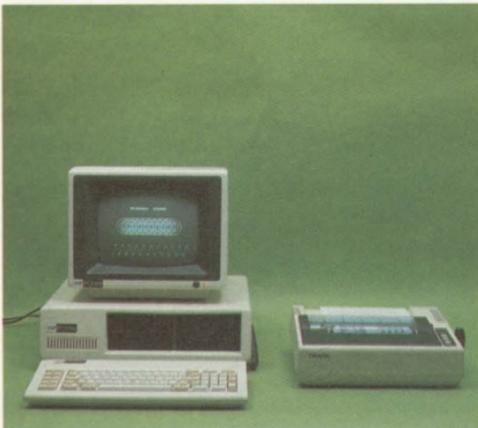
A unidade central do Link 727 e do PC 2001 utiliza o microprocessador de 16 bits 8088 da INTEL. Na versão usualmente comercializada, o microcomputador possui 256 kbytes de memória principal, com 40 kbytes de ROM.
