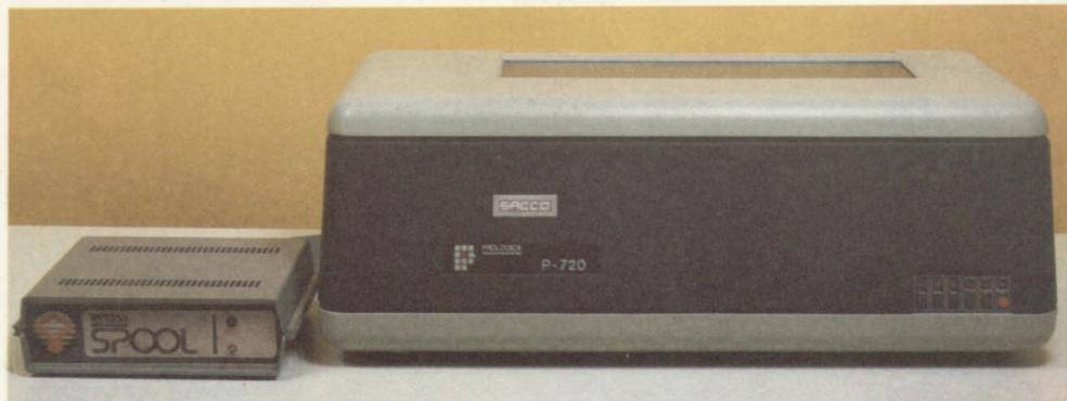
Com a interface de spooling BYTESSPOOL pode-se usar transmissão serial ou paralela; a vantagem da transmissão em paralelo é que se obtém maior velocidade, já que os 8 bits de um caractere são transmitidos ao mesmo tempo, o que não acontece com a transmissão serial, que se processa 1 bit por vez.
