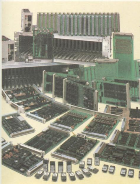
Muitas placas de interface industrial foram projetadas para sistemas de controle baseados em microprocessador. Para facilitar sua compatibilidade com o maior número possível de sistemas, normalmente têm barramentos com distribuição de linhas padronizadas.
