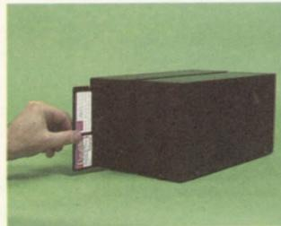
As unidades de disquete dispõem de um controlador próprio, conectado externamente ao barramento do sistema, e podem ser de densidade simples (100 k) ou dupla (138 k).
