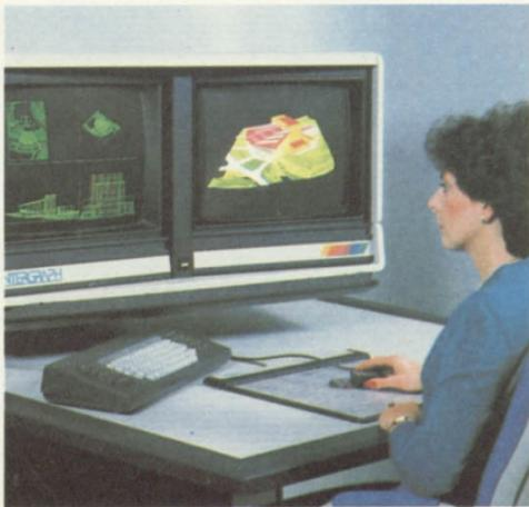
As novas técnicas de projeto auxiliado por computador incluem, além da criação de gráficos e sua rotação conforme os três eixos cartesianos, um efeito zoom, que conserva a resolução gráfica, e o uso de várias cores.
