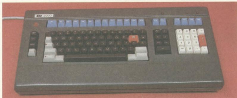
O teclado é eletromecânico, do tipo QWERTY, com maiúsculas e minúsculas. As 112 teclas são divididas em três blocos: alfanumérico, numérico reduzido e de funções.
