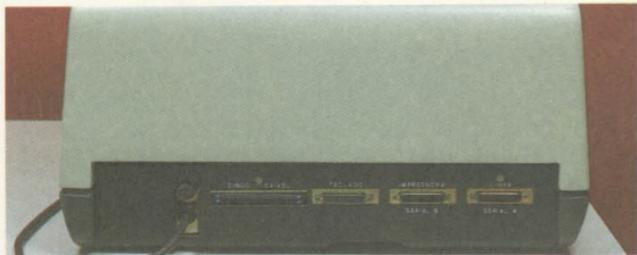
A interface de comunicação pode ser serial RS-232C ou diferencial no SID 3800 e no SID 3900, mas no SID 3300 só pode ser serial. Essas interfaces permitem a ligação de um SID 3000 a outro SID 3000 ou ainda a outros equipamentos, à distância.
