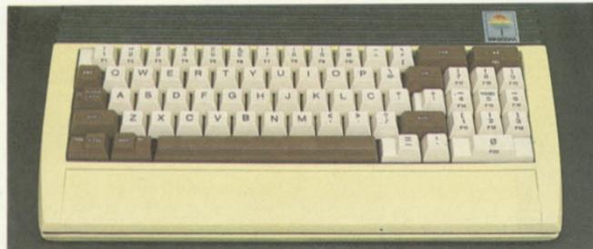
O módulo do teclado é separado do vídeo e contém 69 teclas em disposição tipo máquina de escrever mais um bloco numérico reduzido.
