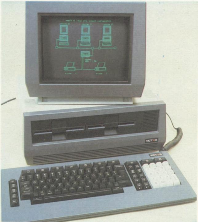
A versão CP/M 86 é empregada por computadores de 16 bits. Este computador incorpora o microprocessador 8088 e é gerenciado mediante essa variante de CP/M.
