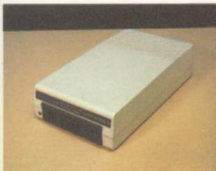
Quando se necessita de maior capacidade de armazenamento e maior velocidade de transferência, usa-se a unidade de discos flexíveis VIC 1541, com capacidade de 170 kbytes cada.
