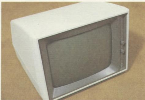
O monitor de vídeo da versão básica é monocromático, em fósforo verde. O formato de apresentação na tela é de 24 linhas por 40 colunas, ampliáveis a 80 colunas mediante uma placa de expansão.
