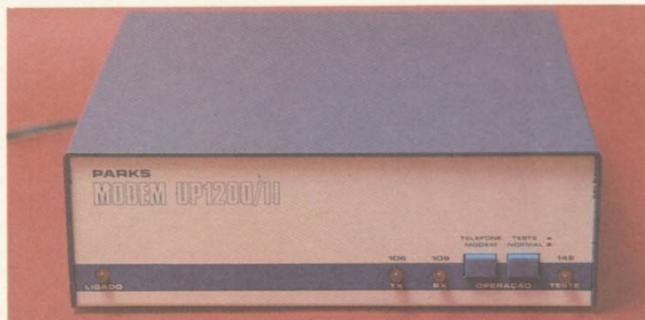
Além dos modelos descritos no artigo, a Parks produz o modem UP 1200/II, com velocidade de transmissão (assíncrona analógica) de até 1200 bps, em modo duplex a quatro fios e semiduplex a dois. A modulação de seu transmissor é em FSK; as frequências são marca 1300 Hz e espaço 2100 Hz.
