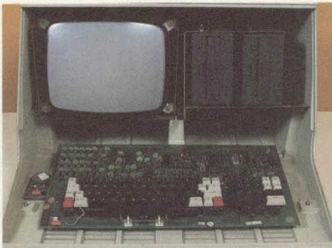
A unidade central do S 700 é construída pelo sistema de monoplaca, que inclui a UCP, a memória principal de 64 kbytes, o controlador de teclado, vídeo, impressora e discos.
