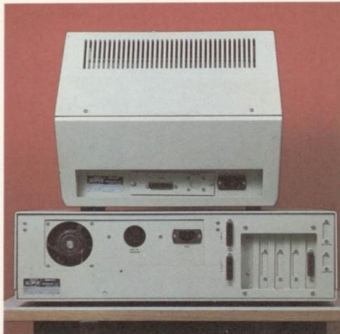
O Nexus 1600 dispõe de conexões para ligação de caneta ótica e para até duas alavancas de controle (joysticks) analógicas, com disparo.
