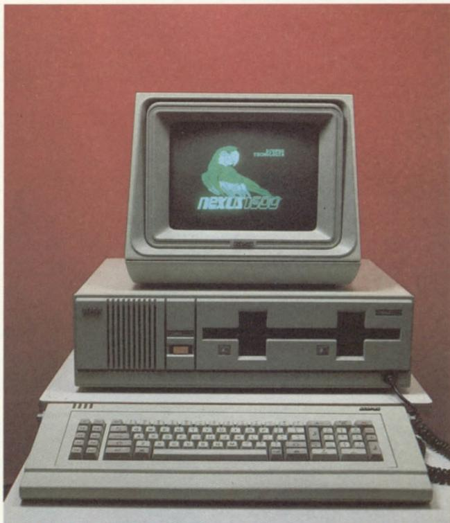
O Nexus 1600, fabricado pela Scopus Tecnologia S.A., é compatível com o microcomputador pessoal da IBM norte-americana. A configuração mínima do Nexus já inclui 256 kbytes de RAM e no mínimo um acionador de disquetes de 5 1/4".
