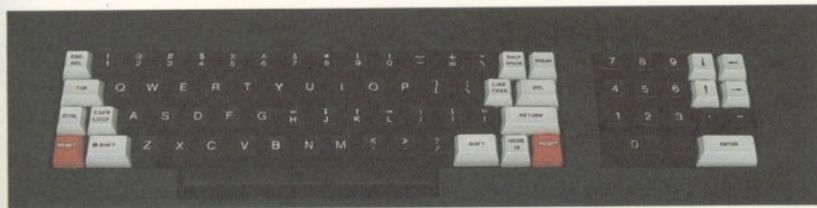
O teclado do S 700 é incluído no gabinete central e consta de blocos separados de máquina de escrever e teclado numérico reduzido.
