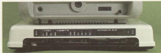
No painel traseiro do console encontram-se os conectores para os variados periféricos padrões, além de botões RESET, liga/desliga, controle manual do gravador e do vídeo. O barramento do sistema é disponível para expansões futuras.
