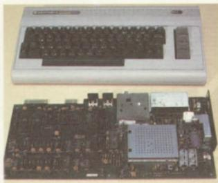
A unidade central de processamento é constituída pelo microprocessador 6510 da MOS Technology, inteiramente compatível com o tradicional 6502, do mesmo fabricante.
