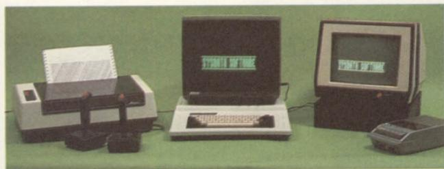
O JR Sysdata pode ser expandido em capacidade, por meio da adição de até quatro unidades de leitura e gravação de disquetes de 5 1/4 polegadas, e impressora.
