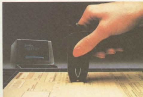
Leitor de caracteres impressos do tipo caneta. O operador tem que deslizar manualmente o periférico sobre o documento que quer introduzir.
