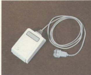
O camundongo é um periférico de entrada gráfica que pode trabalhar sobre qualquer superfície dura. Seu uso simplifica notavelmente a operação do computador, diminuindo a necessidade do teclado.
