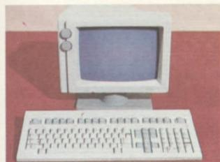
Na versão básica, o monitor é monocromático, de fósforo verde, com características de anti-reflexão. Os controles de contraste e brilho ficam na parte da frente, no alto, à esquerda.
