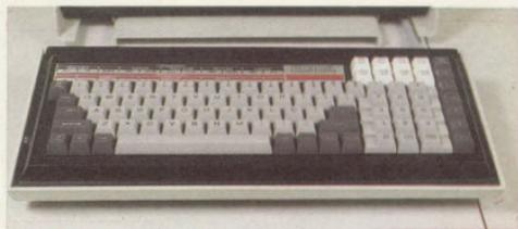
O teclado fica separado do monitor de vídeo, ao qual é ligado por um cabo de até 40 cm de comprimento. Do tipo máquina de escrever, tem 92 teclas.
