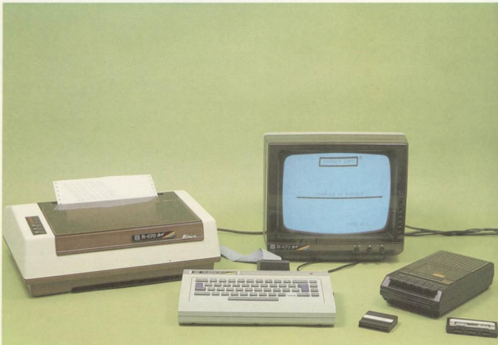
O Ringo R 470 é um microcomputador da faixa de 16 kbytes com interface para ligação de impressora ou máquina de escrever elétrica. Esse equipamento teve sua origem num projeto de construção de um robô industrial para aplicação de botões.
