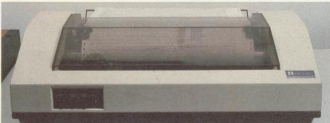
O 1806 pode trabalhar com impressora serial de matriz de pontos, de linha, com taxa de transferência padrão de 9600 bauds, ou então com impressora paralela padrão Centronics.
