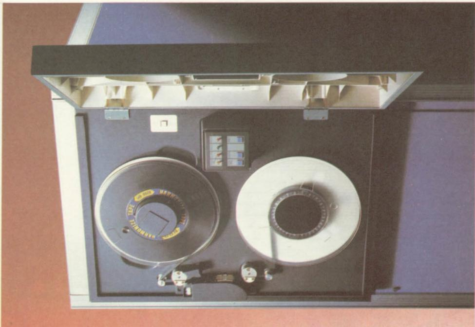
As fitas magnéticas constituem um dos suportes mais utilizados para armazenamento sequencial de informações, embora as fitas de rolo normalmente não sejam usadas em microcomputadores.
