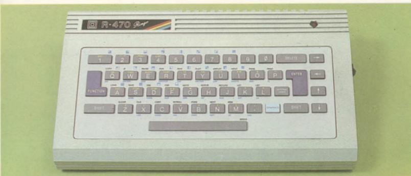
O teclado é do tipo máquina de escrever, com 49 teclas e 155 funções. Além das teclas alfanuméricas de edição, há as de introdução de comandos e de funções específicas e gráficos.
