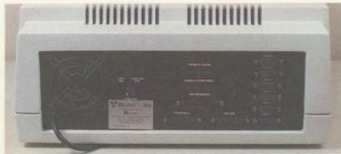
Além de interfaces para unidade de disco rígido e acionador de disquete, o 1806 tem duas portas seriais RS-232C (uma delas assíncrona), seis portas seriais RS-422 e uma porta paralela, de 36 pinos.
