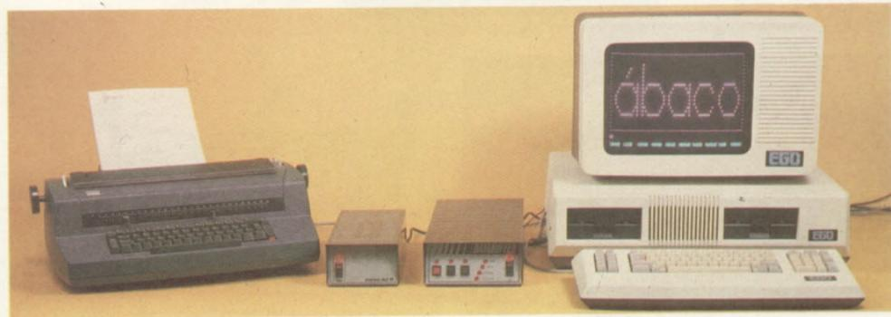
A interface Ábaco modelo 85 permite a utilização de uma máquina de escrever elétrica IBM de esfera como periférico de saída (impressora) de qualquer computador. Ela é controlada por um microprocessador acoplado a uma memória interna de transferência.
