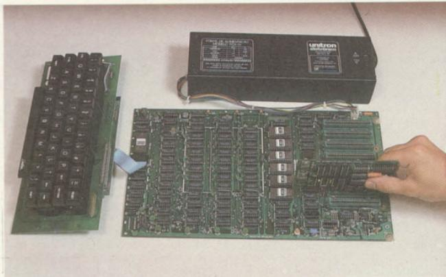
Além do microprocessador de 8 bits de dados e 16 bits de endereçamento, da memória ROM e da memória RAM, a placa-mãe contém os controladores para vídeo, para gravador cassette e para dois potenciômetros de entrada, bem como oito soquetes.
