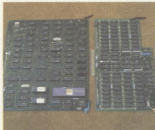
O microprocessador é um Motorola 68000, de 32 bits de palavra. Uma interface opcional permite a conexão desse computador a uma rede local composta de até três Lisas.
