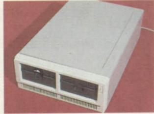
A unidade central pode ser deslocada à vontade do operador, dentro dos limites impostos pelo comprimento do cabo que a liga ao teclado. Nela fica a unidade dual de acionamento de disquetes.
