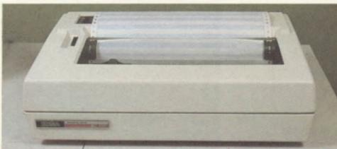
A interface RS-232C permite a ligação de uma impressora de matriz de pontos, com velocidade de 100 cps e capacidade de 132 caracteres por linha.
