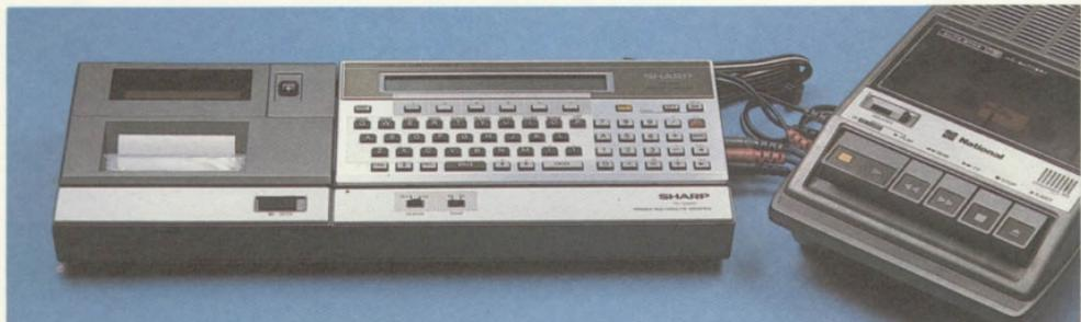
Enquanto seu antecessor PC 1211 era classificado pelo próprio fabricante como calculadora programável, o PC 1500 da Sharp é um microcomputador de bolso. Além de gravador, o periférico disponível para esse modelo é uma mini-impressora gráfica em quatro cores.
