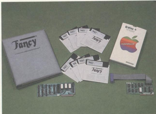
FANCY é um sistema de programação estruturada em linguagem sem natural e de gerenciamento de banco de dados para microcomputadores compatíveis com a linha Apple II. Uma placa de circuitos impressos contendo um microprocessador Z 80 e uma memória ROM com firmware é parte integrante do FANCY.
