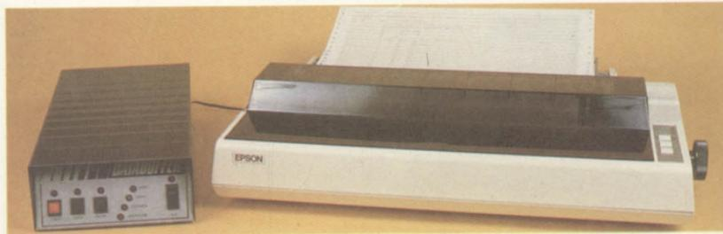
Além da interface para máquina de escrever, a Ábaco produz também o Databuffer, memória intermediária que permite liberar o microcomputador da tarefa de controlar a impressora acoplada a ele. Existem duas versões: uma de 16 e outra de 64 kbytes.
