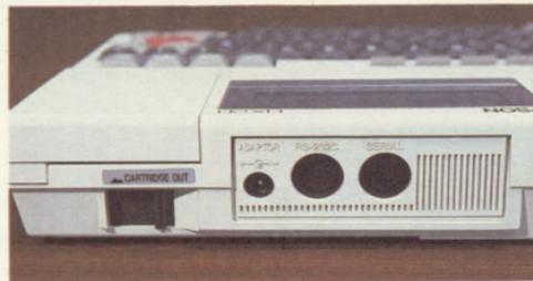
Detalhe dos conectores frontais do sistema: conectores DIN para as interfaces RS-232 e serial, tomada para o adaptador de corrente contínua e tecla para a extração do microcassete.
