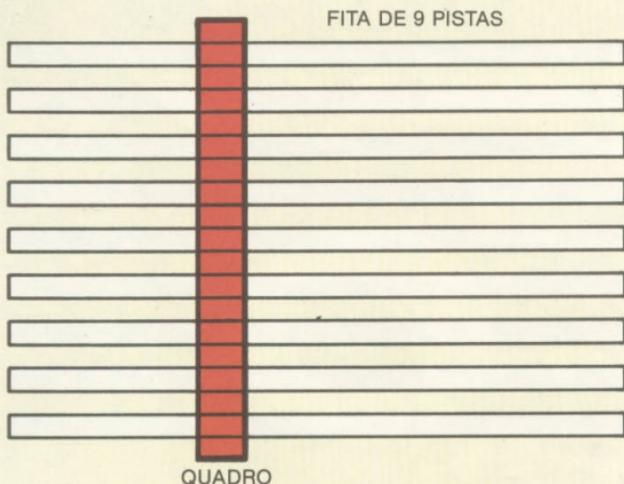
Dá-se o nome de quadro (frame) à linha vertical que contém a codificação de um cartucho. Para realizar uma leitura ou gravação é preciso situar a fita de forma que o quadro desejado coincida com o cabeçote ou dispositivo de leitura/gravação da unidade.
