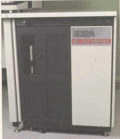
Na parte superior esquerda do gabinete aparece a chave de três posições (DES/LIGA/LIGA/CARREGA); logo abaixo, as entradas para discos flexíveis de 8 polegadas que constituem a memória auxiliar.
