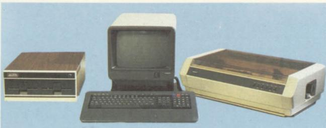
*O sistema MP/M é um sistema operacional compatível com o CP/M para microcomputadores de 8 bits que operem em multitarefa. A UCP do computador acima é um Z 80, compatível com o MP/M.*
