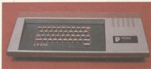
O teclado do CP 200 tem teclas mecânicas simplificadas dispostas em uma matriz de cinco fileiras. O CP 200 é o único modelo a apresentar duas teclas de RESET, que precisam ser pressionadas simultaneamente, e duas teclas de SHIFT.
