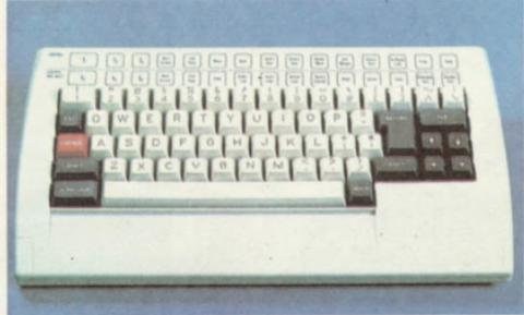
O teclado — independente da unidade central — é do tipo QWERTY, com 60 teclas. Possui quatro teclas para movimentar o cursor, clique audível e repetição automática ajustável.
