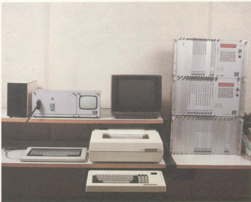
Além de ser um controlador lógico programável, o HSC 1000 pode funcionar como microcomputador comercial. Periféricos como teclado profissional, monitor de vídeo, impressora, acionador de disquetes e programador de EPROM podem ser ligados ao equipamento central.
