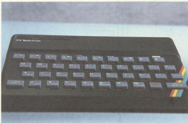
A configuração básica do microcomputador ZX Spectrum, comercializado pela empresa britânica Sinclair, consta de um gabinete simples que contém a UCP e o periférico elementar de entrada de dados: o teclado. Essa simplicidade, compartilhada por muitos computadores similares, é o que faz seu custo ser baixo.
