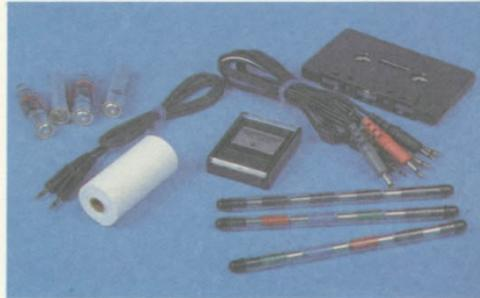
Os acessórios fornecidos com o PC 1500 incluem suprimentos básicos, como canetas para a impressora, baterias de reserva, papel, etc., assim como um conjunto de manuais de operação e programação.
