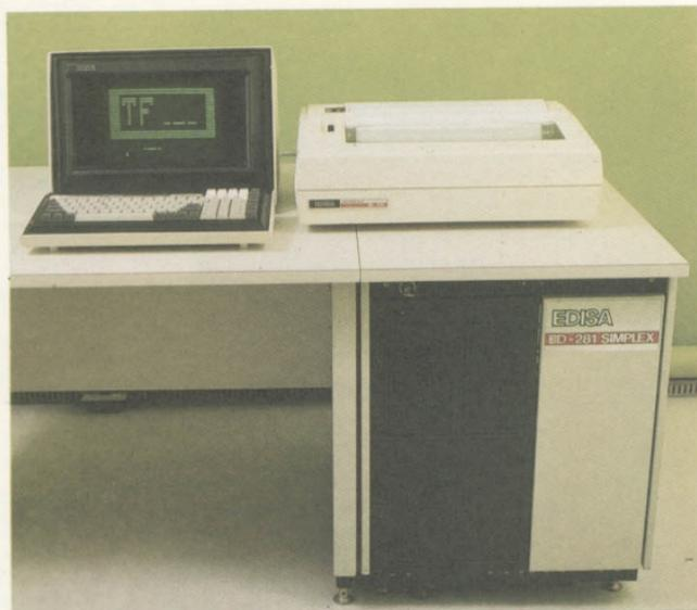
Configuração do ED 281 Simplex com unidade central, monitor de vídeo, teclado e impressora serial. O equipamento pode também ser conectado a leitora de caracteres e emular terminais IBM.
