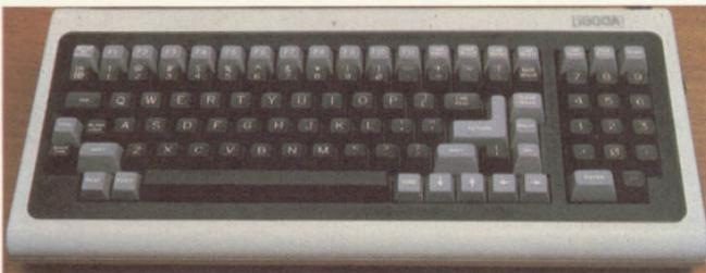
O teclado usado com o Telsist 1806 é eletromecânico e obedece ao padrão QWERTY; possui bloco numérico reduzido (do lado direito) e tem também diversas teclas de função.
