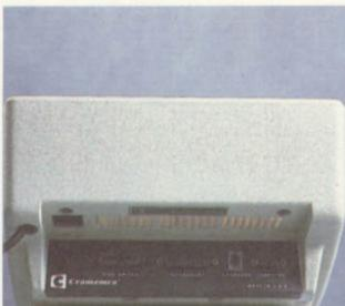
A unidade de disco conectada com o C10 tem capacidade de armazenamento de 390 kbytes. É possível, mediante um sistema de conexão, usar até quatro unidades de disco flexível ao mesmo tempo.
