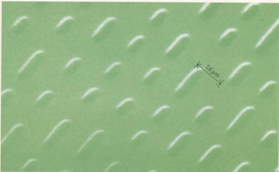
Fotomicrografia eletrônica que mostra os orifícios realizados por laser sobre uma delicada película de metal. A distância entre os furos é de 1,6 μm.
