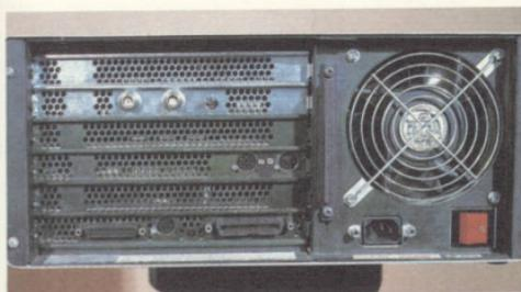
Na parte traseira da unidade central ficam as conexões que permitem a ligação com periféricos e as ampliações. Pode ser feita a conexão com praticamente qualquer marca de mainframe, além de com outros equipamentos da própria Wang.
