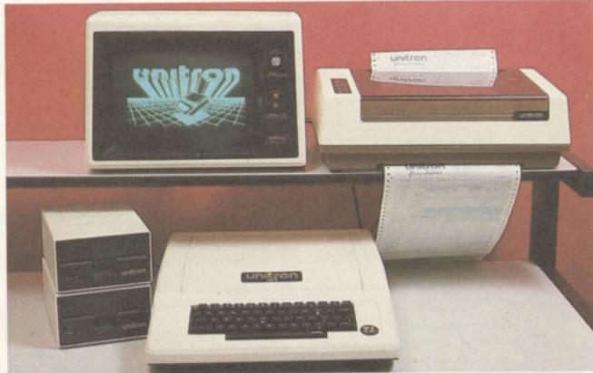
Lançado no mercado em julho de 1982, o Unitron Ap II foi um dos primeiros microcomputadores inteiramente compatíveis com o Apple II norte-americano. Como o modelo original, tem gabinete único, com teclado integrado, e unidade central em uma só placa.
