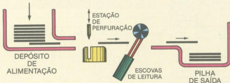
*Na maioria das máquinas auxiliares destinadas à perfuração de cartões existem três partes bem diferenciadas: o depósito de alimentação, a estação de perfuração e o depósito receptor (pilha de saída). Quando a máquina é também capaz de ler os cartões, distingue-se uma quarta parte, que são as escovas de leitura.*
