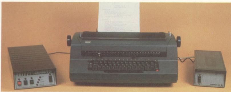
*Para funcionar como terminal de saída de computador, a máquina IBM precisa ser adaptada para acionamento eletromecânico por meio de solenóides. Isso não altera, porém, seu desempenho como máquina de escrever elétrica.*
