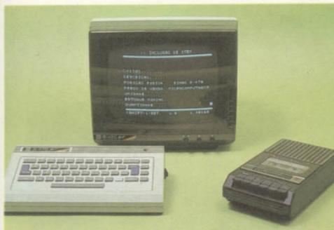
Podem ser acoplados ao Ringo qualquer receptor de televisão, branco e preto ou em cores, e qualquer gravador cassette que tenha entrada AUX e saída EAR.
