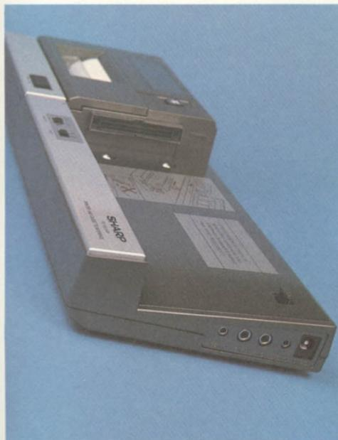
A impressora é alimentada por uma bateria recarregável de níquel-cádmio. O terminal da extrema direita serve para a conexão de um adaptador de corrente alternada à interface, o que permite a recarga da bateria.
