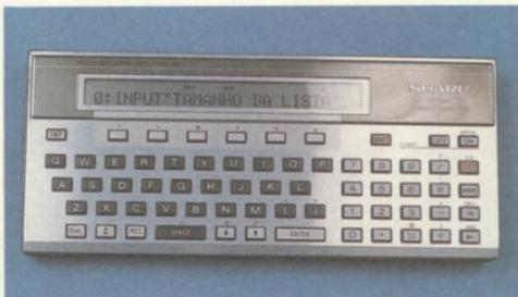
O teclado do PC 1500 tem blocos separados para a digitação de valores numéricos e operações (modo de utilização como calculadora) e também um bloco de teclas com a mesma disposição de uma máquina de escrever.
