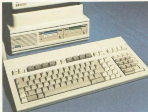
O teclado, independente da unidade central, está dividido em vários subconjuntos de teclas: conjunto de caracteres de máquina de escrever, bloco numérico reduzido, teclas de função e teclas de controle do cursor. O total é de 107 teclas.
