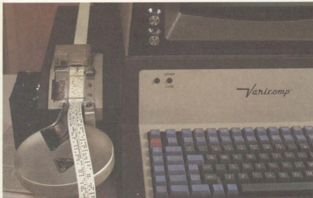
Quando se deseja que o computador entregue a informação em fita de papel é preciso utilizar unidades de perfuração como essa de figura. Seu funcionamento baseia-se em uma bateria de punções.
