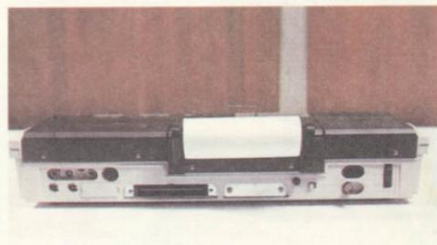
*Na parte posterior do equipamento estão as conexões para uma unidade exterior de cassette, duas tomadas independentes para receptor de TV ou monitor de vídeo, uma saída para joystick e, opcionalmente, um conector paralelo e outro serial.*
