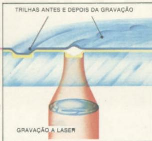
Micrografia dos canais de um disco gravado a laser. A difração produzida no feixe de raios laser pelas bolhas da película metálica constitui a base do processo de leitura das informações gravadas nesse tipo de disco.
