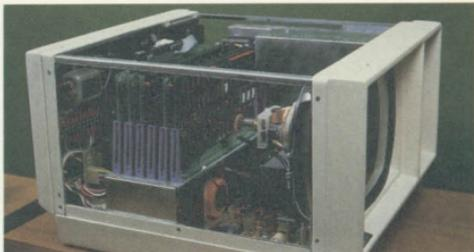
A unidade central de processamento do QI 800 é baseada no microprocessador Z 80A, operando à velocidade de 4 MHz. A memória principal é do tipo dinâmico, com 64 kbytes de capacidade, montada em uma placa única.
