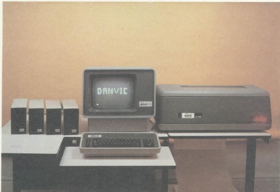
Microcomputador DV 400 Caçula configurado com quatro acionadores de disquete de 5¼" e impressora DVM 720, de fabricação da própria Danvic. O equipamento trabalha com o sistema operacional CP/M 2.2 e é compatível com o Sistema 700 da Prologica.
