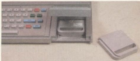
O acoplamento de cartuchos de ROM, com capacidade total de até 16 kbytes, é feito graças a um recesso e a um conector múltiplo existentes em um compartimento com tampa, na parte direita do teclado.
