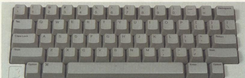
O teclado é ligado numa tomada existente na parte direita inferior do gabinete principal. Com 58 teclas na versão padrão, ele pode ser complementado por um bloco numérico separado.
