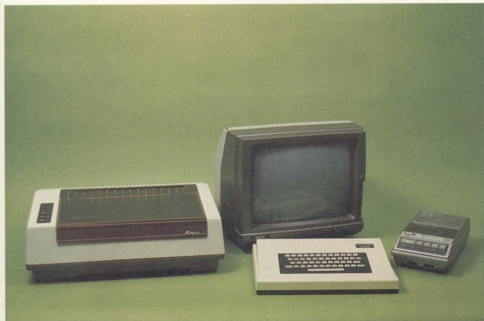
Outros periféricos com protocolo de comunicação serial, como impressoras e traçadores digitais, podem ser conectados ao micro através da porta serial RS-232C.
