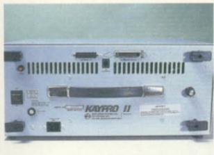
Na parte posterior da unidade central, estão as conexões para a impressora e para o teclado, além da conexão e o interruptor de alimentação. Acima à esquerda, o botão para partida a frio.
