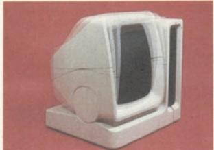
Englobado no gabinete da unidade central, o monitor de vídeo do microcomputador tem um pedestal inclinável, com rotação transversal.
