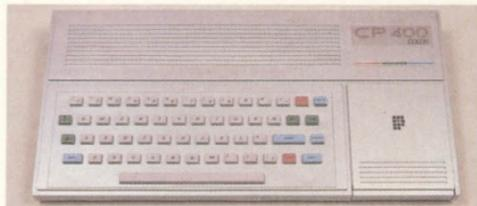
O teclado é do tipo mecânico simplificado (chiclete), de acionamento por contato, com 55 teclas na tradicional disposição QWERTY adotada nas máquinas de escrever. Todos os caracteres ASCII podem ser acessados.
