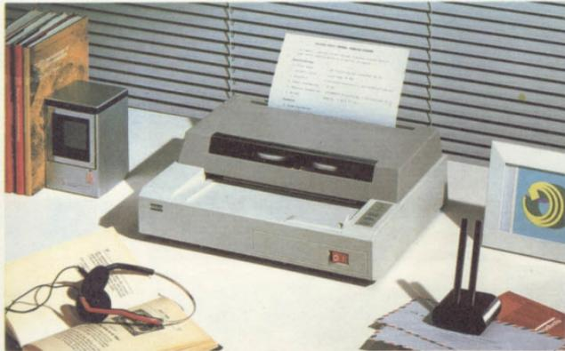
O periférico da figura é o modelo TP-16 da Fujitsu e é um exemplo importante de impressora que utiliza a transferência térmica como modo de impressão. A velocidade de impressão é de 54 cps, e a máquina pode imprimir inclusive sobre películas plásticas.
