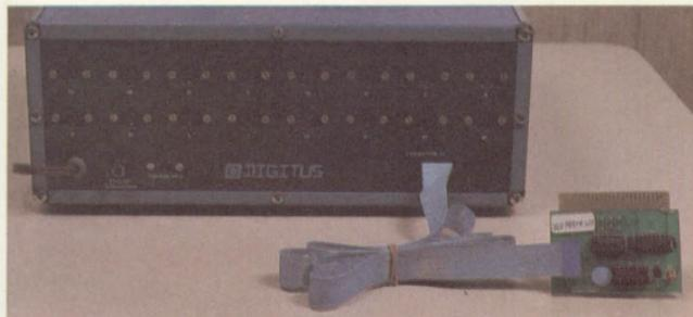
Os conectores de trás do Digiplex são marcados de A a P. Os cabos de conexão das estações podem ser encaixados aleatoriamente; o micro central define as estações nas 16 posições.
