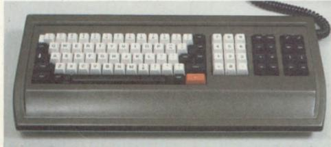
Além do bloco alfanumérico padrão e do numérico reduzido, o teclado do Cobra 210 tem dois blocos de controle e funções, cuja ação depende do sistema operacional em uso.
