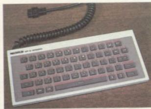
A configuração expandida do MPF II conta com teclado profissional em separado do gabinete principal, ao qual é conectado por meio de um fio em espiral.
