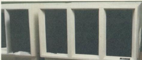
As unidades de discos flexíveis de 8 polegadas, incluídas no gabinete da unidade central, podem ter face simples ou dupla, chegando à capacidade individual de mais de 1 Mbyte. Duas unidades adicionais ou um disco Winchester de 5 Mbytes podem integrar o sistema.
