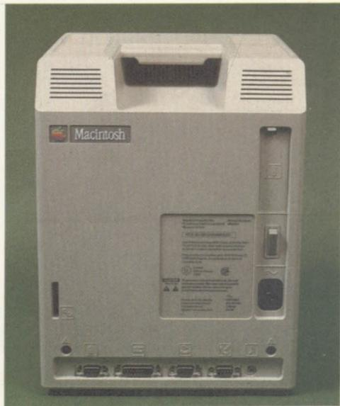
Na parte de baixo, vê-se, da esquerda para a direita, o conector do camundongo, o conector para acionador externo de microdisquetes, as portas do barramento serial e a porta do gerador sonoro.
