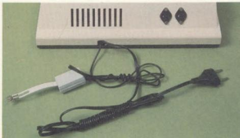
O painel traseiro do console incorpora portas de acesso para gravador cassette, TV e fonte de alimentação, além de uma porta serial RS-232C e acesso ao barramento do sistema.
