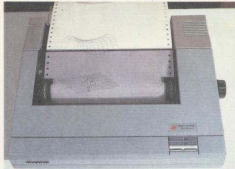
Mediante a interface paralela, podem ser ligados ao MZ 700 diversos tipos de impressora. Essa ligação, porém, impede o uso simultâneo da impressora/plotter incorporada no móvel da unidade central.
