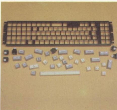
O alinhamento preciso das teclas é conseguido mediante o emprego de uma máscara de metal perfurada, montada sob o teclado.
