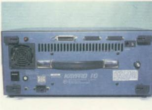
O modelo Kaypro 10 mostra, na parte posterior da unidade central, um conector para modem. O equipamento dispõe ainda de uma unidade de ventilação para manter a refrigeração adequada.
