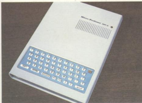
A unidade central é de dimensões reduzidas; além dos circuitos do microcomputador, nela está um gerador de sons programável, com alto-falante e amplificador integrados no sistema.
