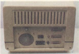
O Manager II tem interface de comunicação RS-232C, interfaces para impressoras sérias, controladores para disquetes e para unidades de disco rígido de tecnologia Winchester.
