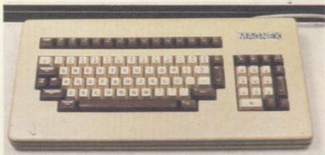
O teclado fica separado da unidade central e do vídeo; é do tipo profissional, com módulo alfanumérico, módulo numérico reduzido e módulo de funções (neste, 14 teclas são programáveis).
