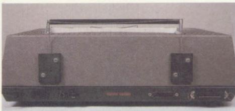
A troca de formato de impressão pode ser feita tanto por software como por hardware, isto é, por comando emitido pelo computador ou por uma dip-switch na parte de trás do equipamento.
