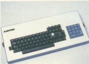
O teclado é independente da unidade central e é ligado a ela por meio de um cabo em espiral. Contém um total de 76 teclas, agrupadas em dois blocos e é o mesmo para os três modelos.
