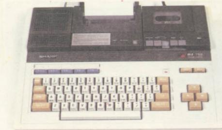
*A unidade central baseia-se no microprocessador Z 80A. No mesmo móvel está incorporado o teclado, formado por 69 teclas, na disposição QWERTY. Do total das teclas, cinco são para a definição de 10 funções programáveis.*
