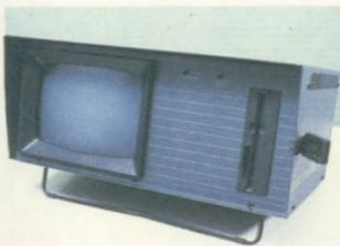
A linha Kaypro tem três modelos: II, 4 e 10, que se diferenciam pela capacidade de armazenamento em disco. Na foto, unidade central do modelo 10, que inclui um disco rígido de 10 Mbytes.
