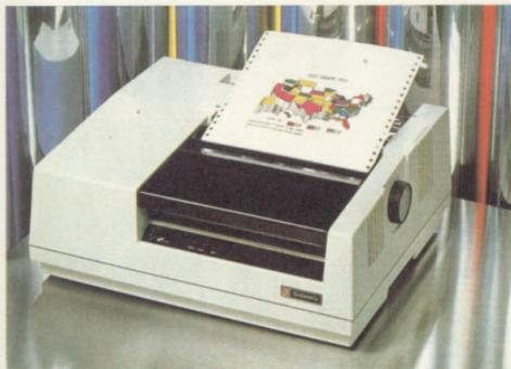
A série CHC 30 de impressoras em cores apresentada pela Shinko utiliza também a transferência térmica como forma de impressão. Esses periféricos são muito úteis para executar gráficos em cores, em projetos auxiliados por computador (CAD), controle de processos, etc.
