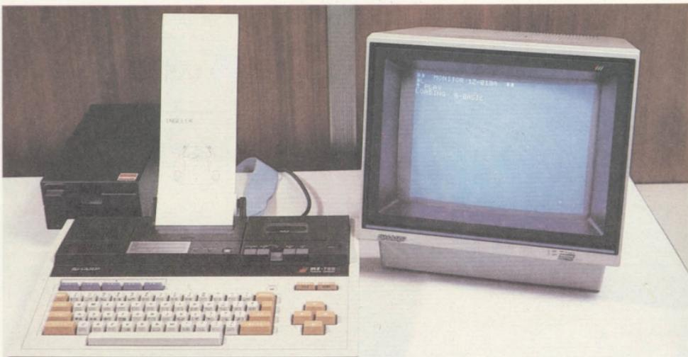
Sharp 700 é uma família de microcomputadores que funcionam em sistema monousuário, orientados fundamentalmente para aplicações domésticas e de amadores. Essa linha é composta de quatro modelos que se distinguem pelo critério de incorporação de periféricos ao gabinete central.
