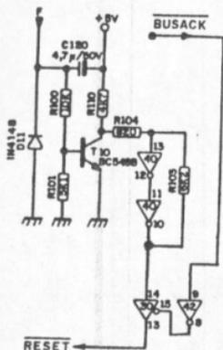
Com isso o BUFFER CI 30 recebe nível lógico " 0 " no pino 14 e via pino 13 aplica-o à CPU ( o pulso de RESET ).
