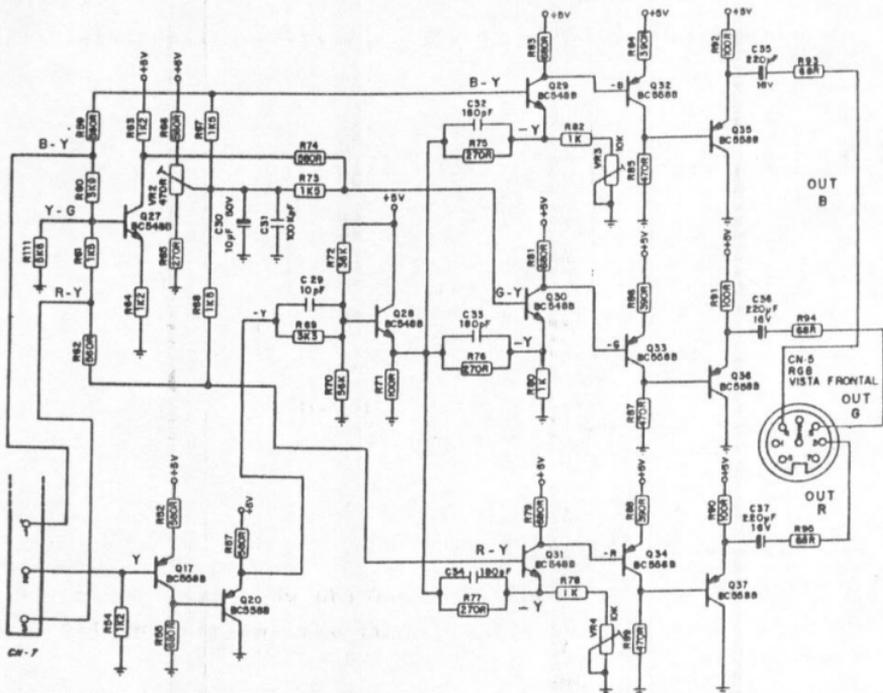
Através de Q35, o sinal B recebe uma amplificação de corrente e daí é enviado via C35, R93 ao pino 4 do CN-5.
