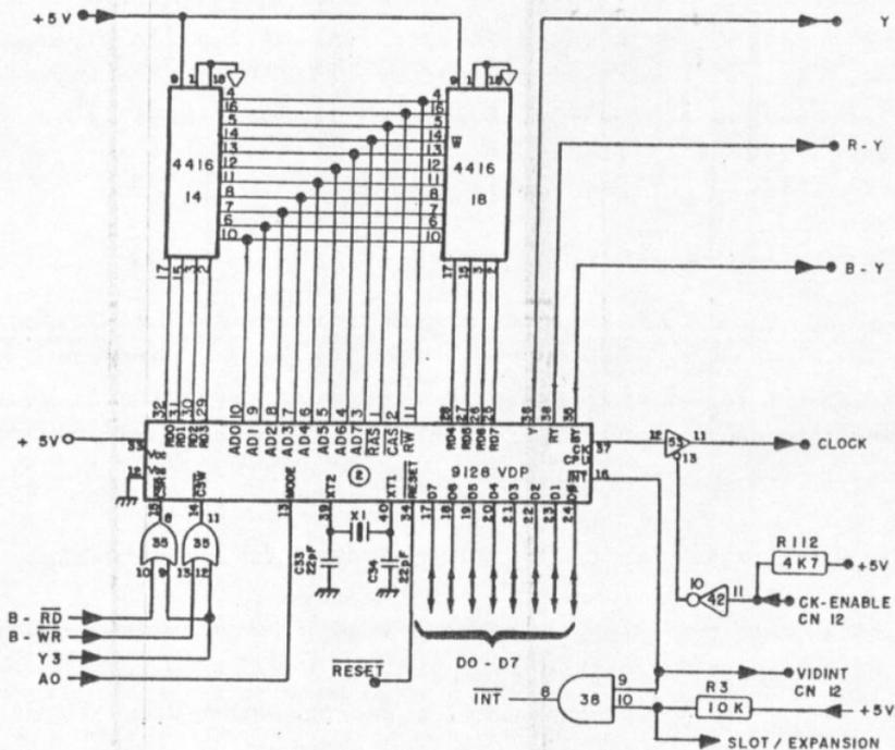
O sinal de interrupção é gerado no fim de cada varredura ativa do display em cada 1/60 segundos, sendo enviado para o CN12 pino 4 e ao CI 38 pino 9, atingindo o pino 16 da CPU com o sinal " INT ", informando a CPU para aguardar pôr um instante o processamento no caso do I/O de vídeo não tiver tido tempo suficiente para terminar a comunicação com a CPU.
