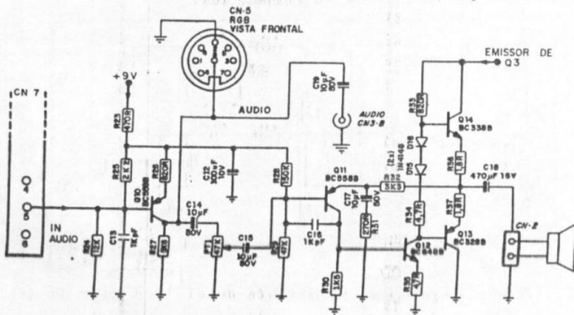
Do coletor do Q10 o sinal de audio prē-amplificado ē enviado para o conector CN-5 pino 8 e, via PT1 ( controle de volume' externo ), o sinal ē aplicado ao amplificador de potēncia " Push-Pull " formado pelos transistores: Q11, Q12, Q13 e ' Q14 e, via C18, ē aplicado ao CN-2 sendo interligado ao alto falante.
