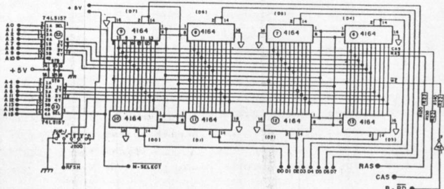
Além disso, as RAM recebem no pino 03 a linha " WRITE-ENABLE " que sai da linha B- $\overline{RD}$  da CPU, passa pelo CI 42 ( BUFFER inversor ) a qual indica se a informação vai ser escrita ou lida.
