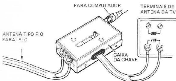
Fig. 8: Conexão no terminal de antena
