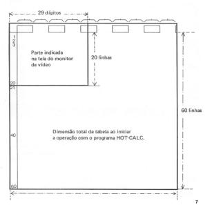
O HOT-CALC possui na realidade a dimensão conforme mostra a figura acima; contendo 56 dígitos (7 dígitos x 8 colunas) e 60 linhas. A imagem transmitida inicialmente no monitor de vídeo é a parte superior à esquerda da figura.
