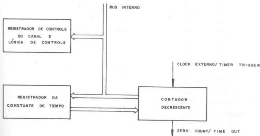
Fig. 5.7 - Arquitetura interna do canal no modo contador.
