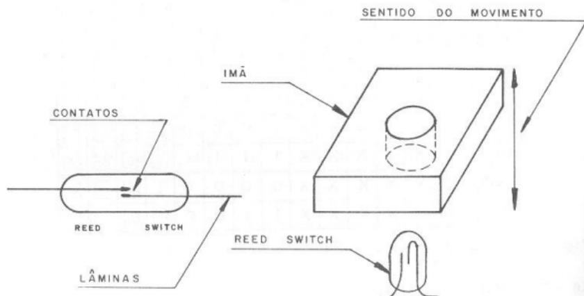
Fig. 8.17 - Detalhes de REED-SWITCH.
