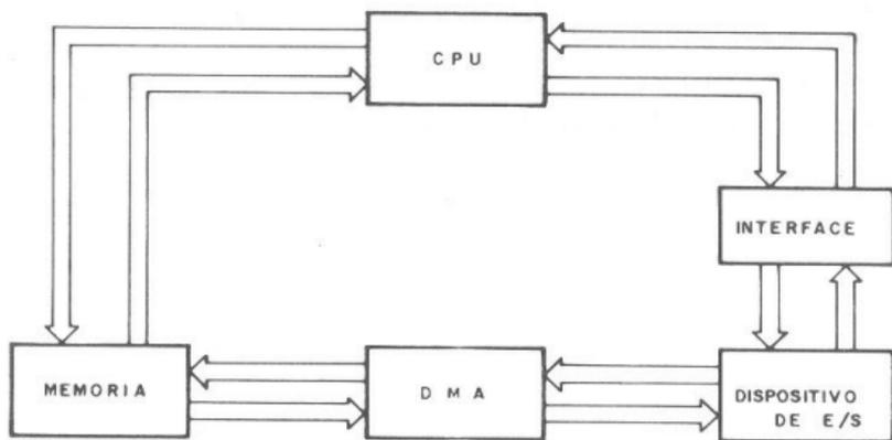
Fig. 1.1 - Sistema Básico de Computação.
