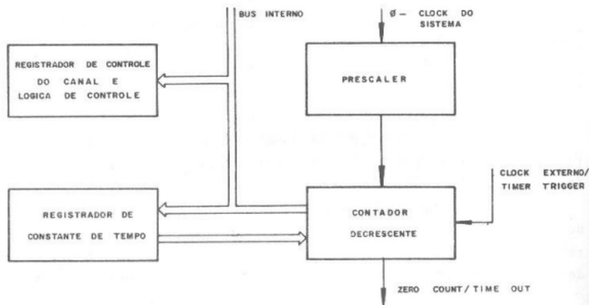
Fig. 5.6 - Arquitetura Interna do canal do modo Timer.
