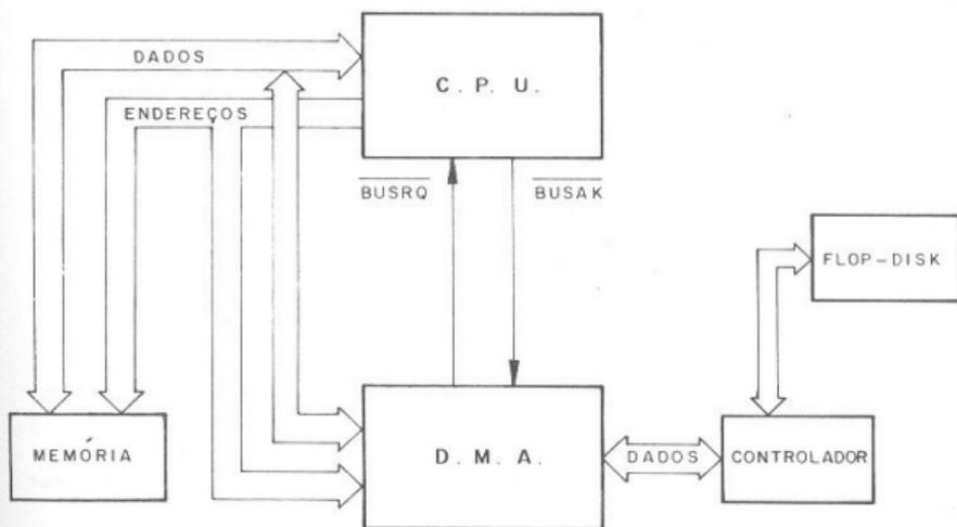
Fig. 4.9 - Esquema para DMA.
