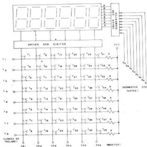
Fig. 8.20 - Diagrama de Interligação Teclado-Display.
