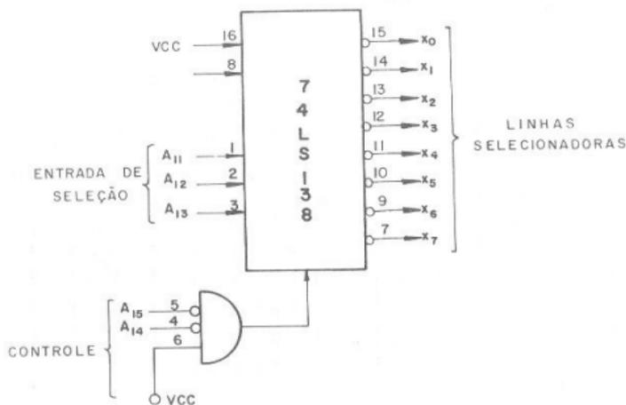
Fig. 8.5 - Esquema geral do 74LS 138 usado na seleção de memória.
