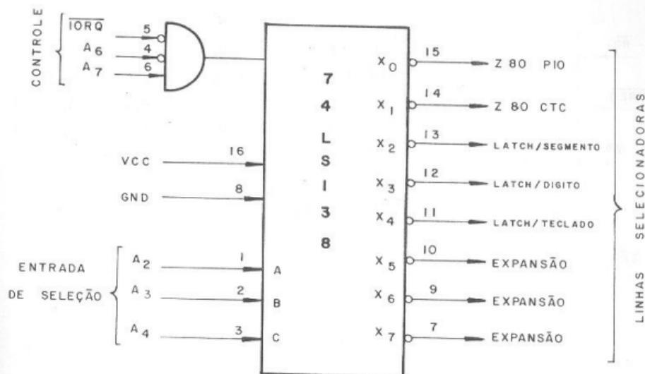
Fig. 8.22 - Configuração do decodificador para a seleção dos dispositivos I/O.
