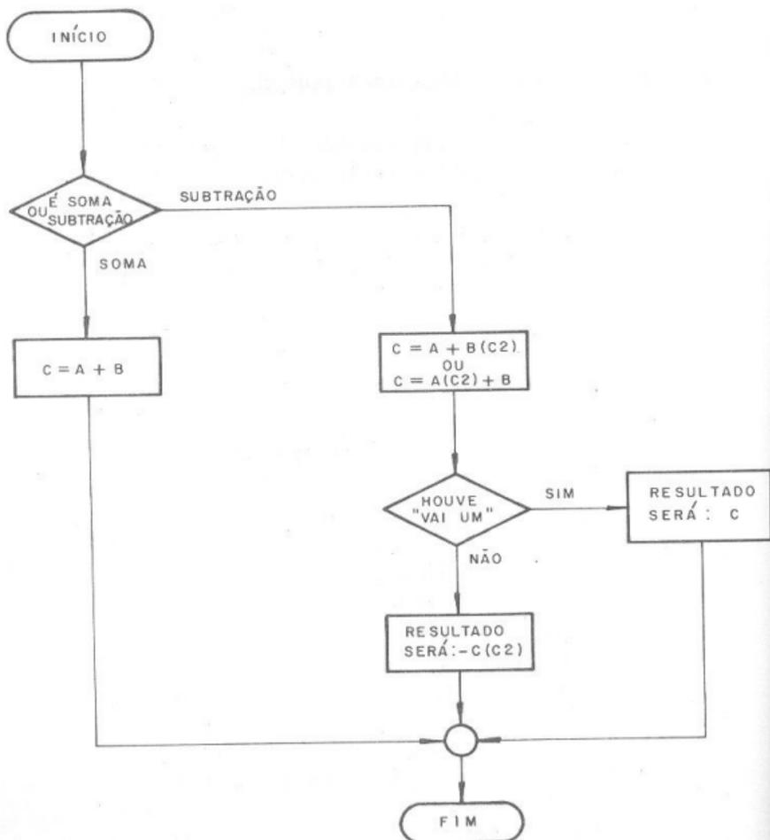
Fig. 2.2 - Fluxo de operações em complemento dois.
