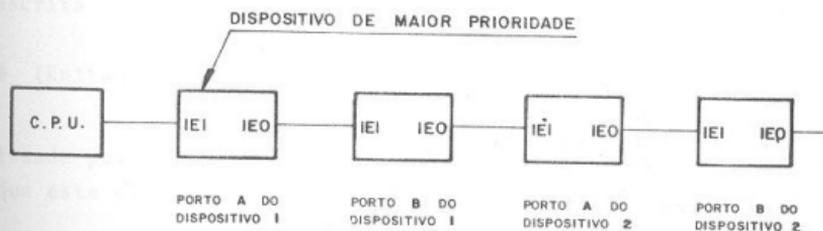
Fig. 6.3 - Configuração DAISY CHAIN.
