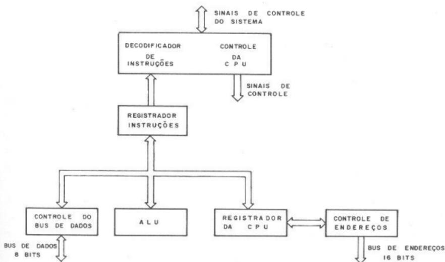
Fig. 3.1 - Diagrama em Blocos da CPU - Z-80.
