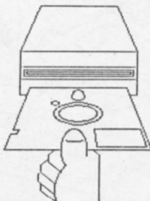
A partir do instante que a trava frontal do drive for acionada, a interface começará a ler o disquete a procura do sistema operacional SOLX-DOS.
