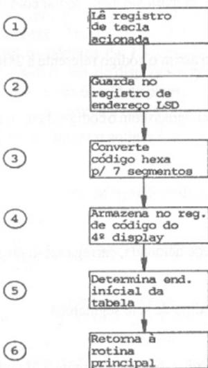
Figura 4.36 - Fluxograma da sub-rotina de 3ª tecla de endereço (3END)
