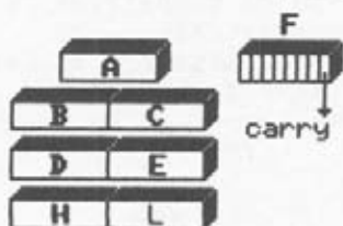
FIGURA 3.2 - O registro interno F e a flag de CARRY.
