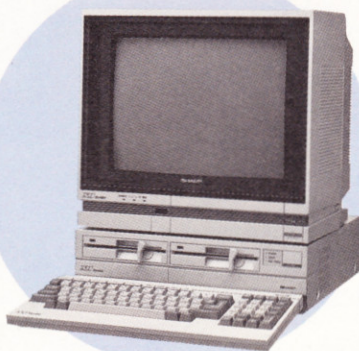
▲パソコンテレビ、X1turboモデル31(シャープ)。AV+コンピュータという概念を打ち出したのだ。
