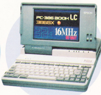
▲エプソンのカラー液晶パソコン「PC-386BOOK LC」。アクティブマトリクス方式で同時16色の表示が可能。
