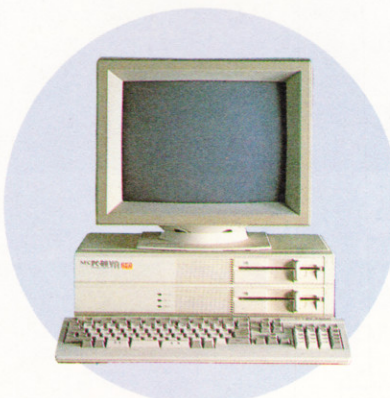
▲98と同じV30のCPU搭載の、「PC-88VA」だけ98のソフトは走らなかった。
