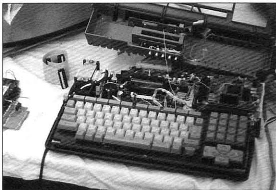
Un Turbo R muy especial en el stand de UMF con el GFX9000 montado internamente, más disco duro, a 40MHz...
