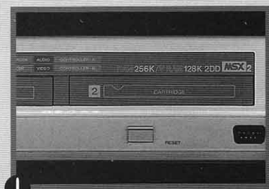
1 Lo primero que debemos realizar es insertar el cartucho en el slot 2 para instalar la BIOS. No es necesario conectar el cable de 40 hilos al disco duro, ya que tan sólo vamos a grabar unos datos en la EEPROM del cartucho.
