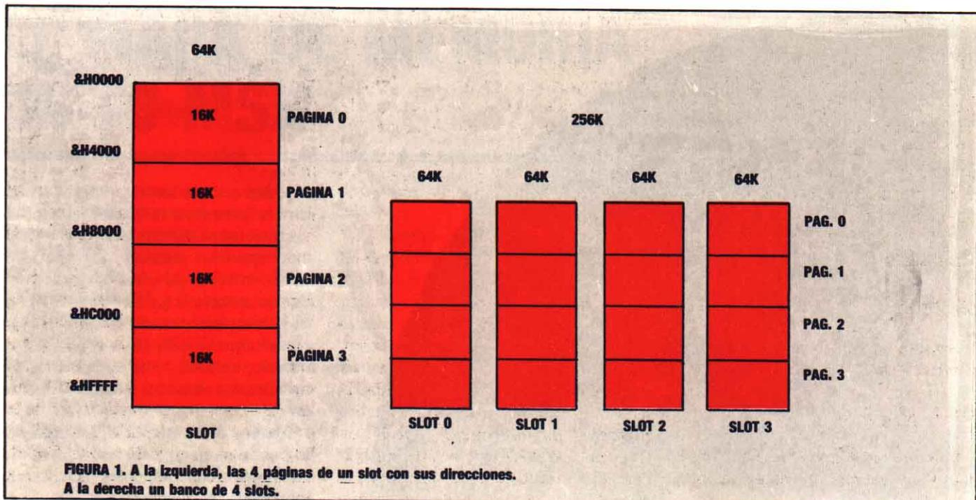
FIGURA 1. A la izquierda, las 4 páginas de un slot con sus direcciones. A la derecha un banco de 4 slots.
