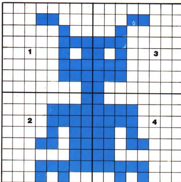
El marcianito de la figura se puede realizar mediante un *sprite* de  $16 \times 16$  puntos formado por 4 bloques de 64 puntos. Cada punto corresponde a un bit que tendrá el valor 1 donde hay dibujo y 0 donde no lo hay.
