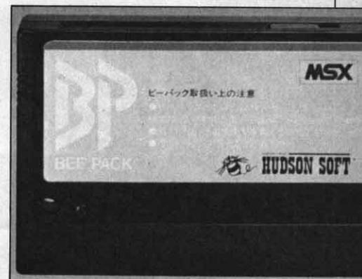
del adaptador son semejantes a las de un cartucho normal y se inserta en el mismo slot. Por la parte inferior tiene los conectores y por la superior la ranura para la tarjeta. Su precio es de unas 2.000 pts. aproximadamente.
