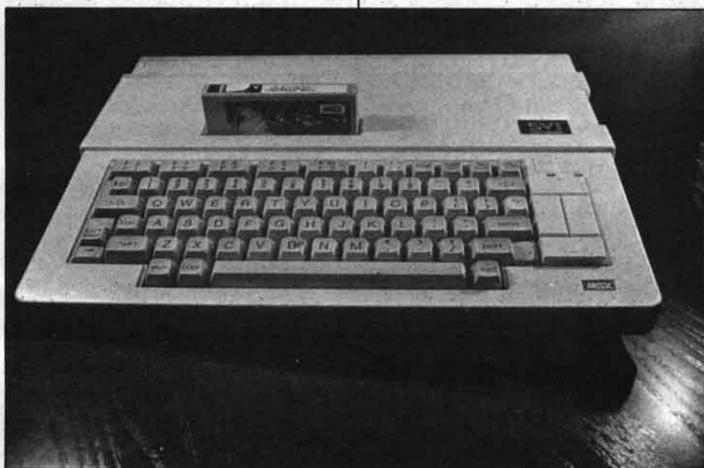
El Spectravideo de la II generación se llama X'Press y es el modelo SVI 738 y tiene 32K de ROM, 80K de RAM e incorpora un modo de texto de 40x80 columnas, una unidad de disco y la salida RS-232. Este aparato ya está a la venta y su precio aproximado es de 99.900 pts.
