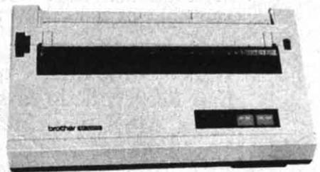
La impresora Brother M-1009 —distribuida por Dynadata—, es de tipo matricial de 9 agujas y puede imprimir a razón de 30 caracteres por segundo. Como todas las que cuentan con una interface de tipo paralelo centronics es compatible con los ordenadores MSX. Su sistema de tracción es por fricción y también de hoja continua. La cabeza impresora tiene una garantía de 20 millones de caracteres de vida. Es baja en sonido y sus prestaciones son buenas.
