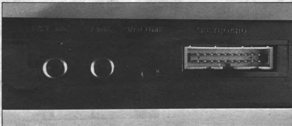
En esta foto las conexiones de entrada HI-FI, el potenciómetro del micrófono y el conector del teclado opcional.
