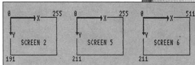
Empezando en 0, 0 horizontalmente hasta 255, 0 ó 511, 0 según la pantalla, se lee una línea completa.
