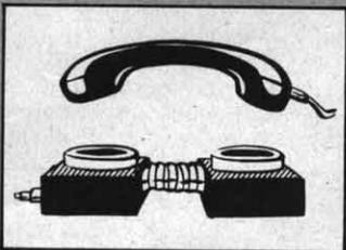
**Acoplador acústico.** Es un dispositivo portátil que permite interconectar un ordenador con la línea telefónica. Resulta muy útil para los hombres de negocio que necesitan acceder a su banco de datos cuando se encuentran fuera de sus oficinas.
