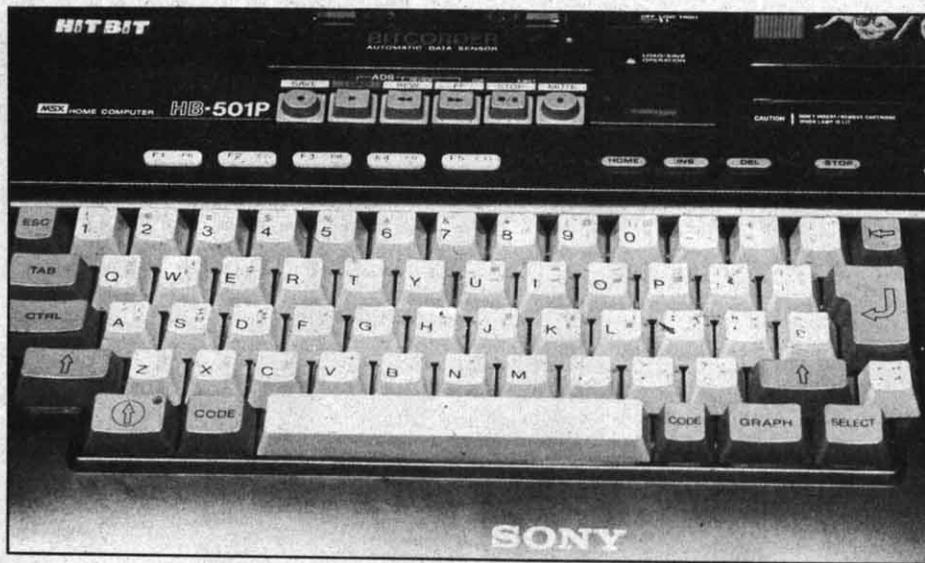
Al estar incorporado en el ordenador, el control remoto del cassette se efectúa de una manera más racional. El "remote" interno sólo se activa para las operaciones en que interviene la tecla PLAY; en otras palabras, permite bobinar y rebobinar sin estar constantemente pendientes de la orden MOTOR o de conectar y desconectar la clavija REMOTE.
