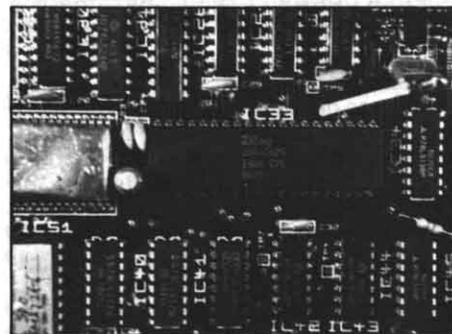
Detalle del microprocesador Zilog Z 80A.
