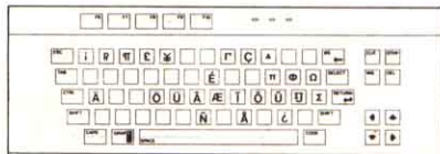
Juego de caracteres cuando se elige la función CODE y se pulsa al mismo tiempo la tecla correspondiente + SHIFT.
