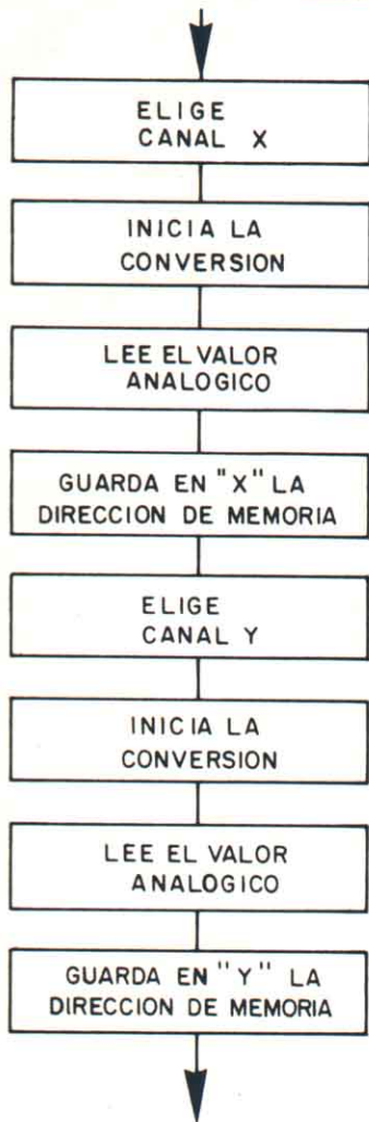
Figura 7. Organigrama de un joystick analógico.
