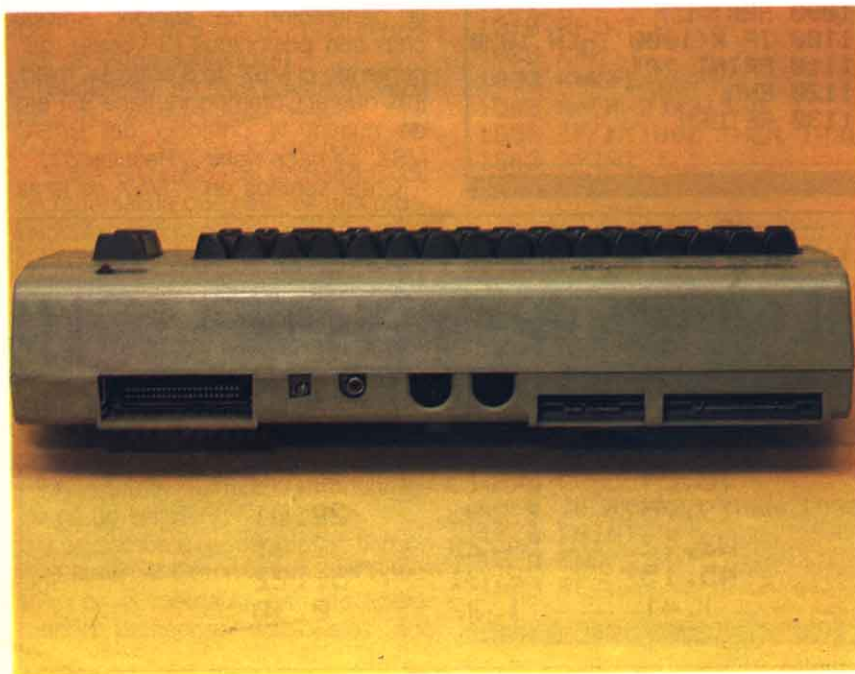
FOTO 5: Vista posterior del Commodore 64. Las conexiones no son estándar, por lo que es necesario utilizar periféricos destinados solamente para este ordenador.
