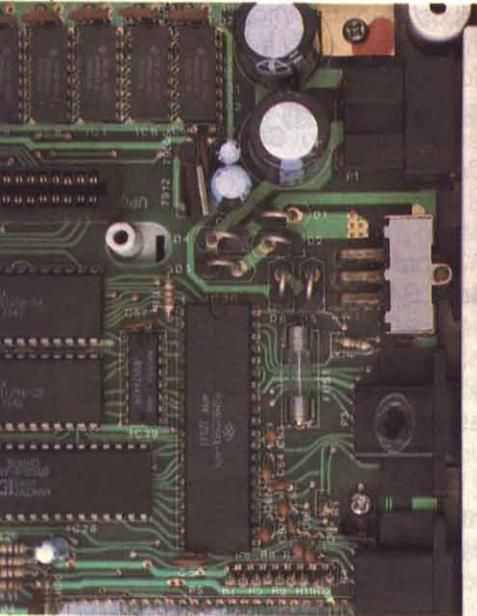
Foto 4. Fusible de protección y conectores de joysticks.
