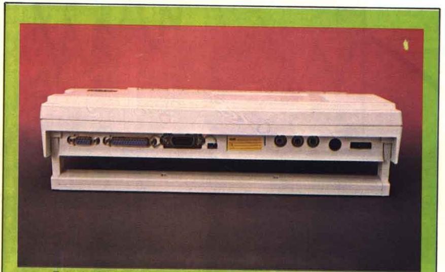
Foto 1. Vista posterior de los conectores que incorpora el SVI-X'PRESS, donde se puede apreciar el RS-232 C.
