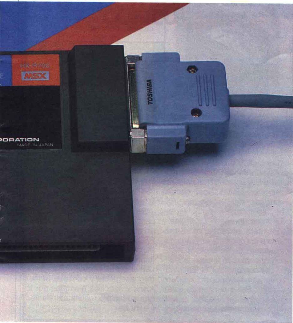
Foto 1: Cable para conectar dos equipos mediante RS-232.
