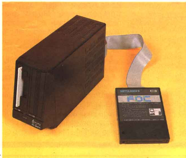
Foto 4. El controlador tiene todo lo necesario para manejar debidamente una o dos unidades.
