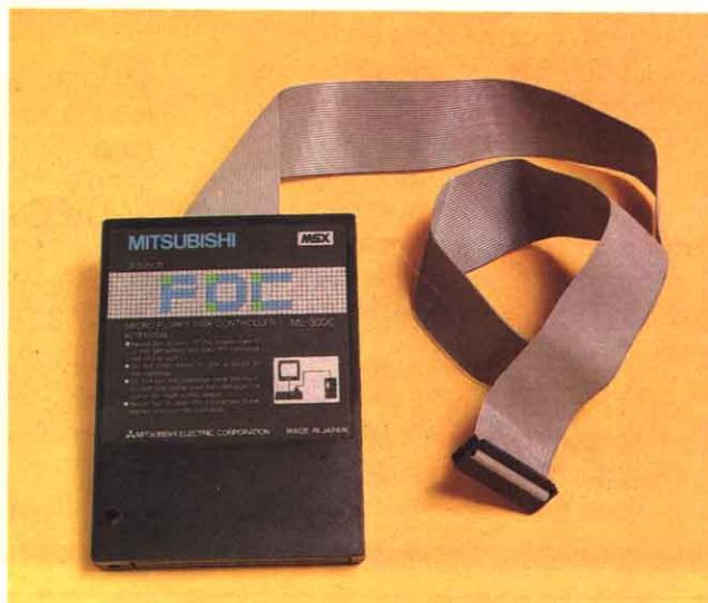
Foto 4. El controlador tiene todo lo necesario para manejar debidamente una o dos unidades.
