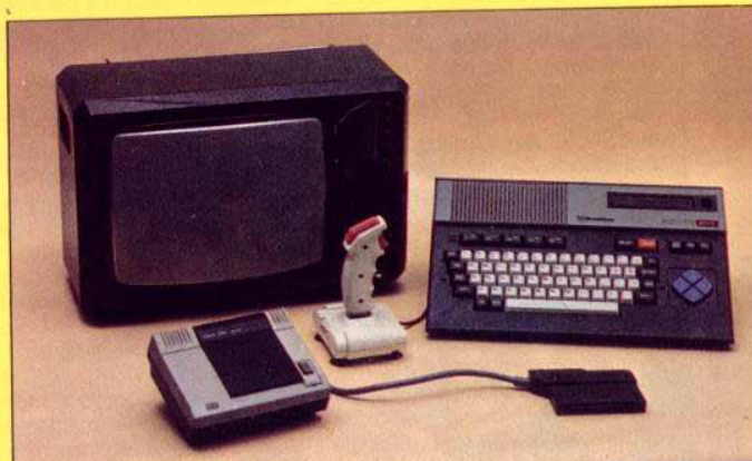
GOLDSTAR 64 K MSX JOYSTICK II MSX QUICK DISK MSX 128 K T.V. COLOR CON EUROCONECTOR
