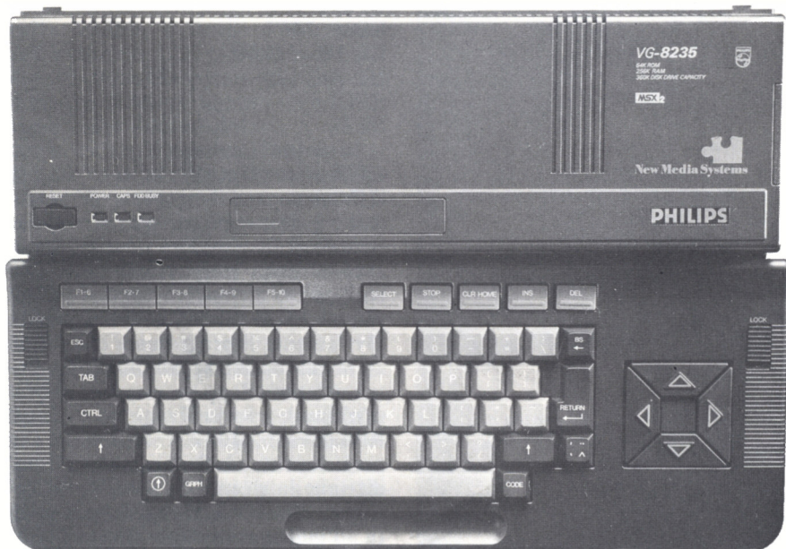
Schermo ad 80 colonne, 512 colori grazie al nuovo videoprocessore, memoria RAM da 256 KB, unità a dischi incorporata: queste alcune delle ottime caratteristiche del nuovo MSX 2 Philips (codice VG 8235) qui sopra nella foto.
