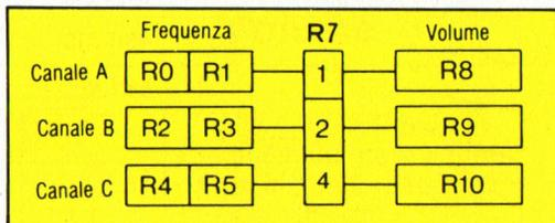
Ogni canale riceve un input quando il suo bit di pertinenza è messo a 0, e lo ignora quando detto bit è a 1.
