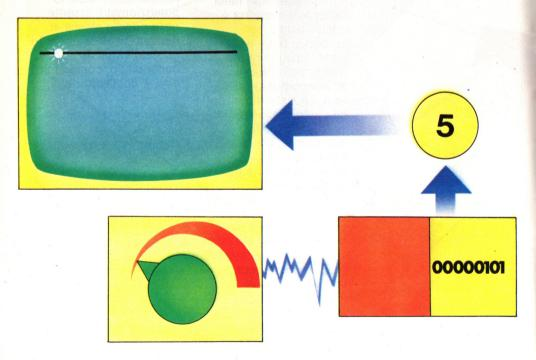
Naturalmente, anche una paddle ha un suo limite di sensibilità, dovuto proprio a tale operazione di conversione: esso risulta comunque estremamente al di sopra di quello del joystick, permettendo in totale 256 possibili combinazioni. Non è però assolutamente detto che una paddle sia meglio di un joystick; dipende infatti dall'uso e dalla sensibilità
