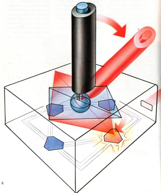
pulsante di fuoco o da segnalatore che la posizione desiderata è stata raggiunta. Tramite programma basterà allora leggere nella locazione il valore di ciascuno di questi bit per risalire alla posizione della leva e quindi alla relativa azione da eseguire (spostamento del cursore, dell'astronave o dell'oggetto sul video).
