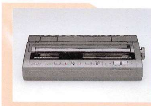
◎高さ70×幅380×奥行き200(4)重さ2.8(kg)。インクリボン1本で2万2千字の漢字が印字可
