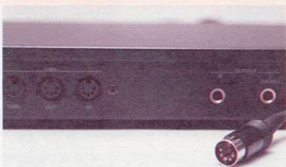
たった5ピンのMIDI端子(左)とどうもMIDIケーブル(右)でつないで情報をやりとりする
