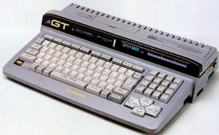
●昨年の見た目は変わらない。変わった点は、MIDIの入出力端子が1つずつ、一方、RF出力廃止、RGBビデオ出力を一本化(専用ケーブルつき)。電源投入後は、『MSXView』の画面
