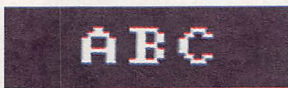
左の写真はSCREEN5以上のグラフィック画面での太文字表現に成功した例で、リストのPRESET命令の最後にある「OR」がポイントだ。
