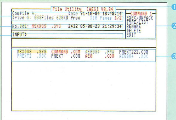
●AEGではファイルの種類を色で識別している。詳しくはドキュメント参照のこと
