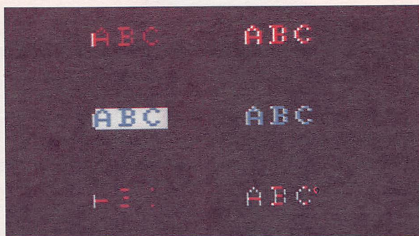
④上からPSET、PRESET、ANDとなっていて、右側の列はTを付けて透明色は演算の対象にしないようにしている。文字の色や論理演算を変えて試してみよう
