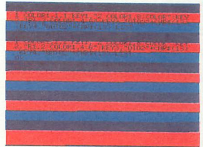
高速に画面の色を切り換えているので、タイミングのせいでこう見えるのだ
