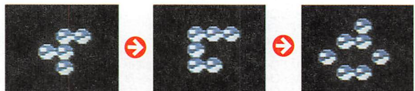
付録ディスクの1枚目にこっそり「大ライフゲーム」を入れた(ファイル名:DAI-LIFE.BAS)。ひとつの石の周囲(8マス)に、ひとつ以下しか石がないばあい、その石は寂しくて消滅。ひとつの石の周囲に、4つ以上の石があつたら、その石は混雑で消滅。ひとつの空白のマスに、3つの石があればそのマスに石が発生。この3つのルールにもとづいて、何度も判定(世代交代と呼ぶ)をくりかえして石の動きを見るゲームだ。写真の左はF型ペンタミノという有名なパターン。そして世代交代のようす
