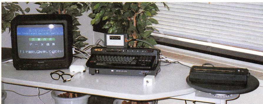
パナソニックのFS-A1WSXと、その下にあるまばたき調整器、カートリッジ、メガネについたまばたきセンサー、フレキシブルスイッチ、呼び出し用チャイム、プリンタでフルセット。テレビはオプションになっている
