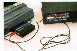
④ビデオデジタイザーを差し込んだターボRとビデオデッキをつないだところ。接続の仕方は39ページの配線図を参照
