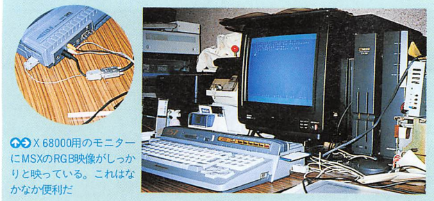
アダプタ本体。8ピンRGB出力を持つすべてのMSXで使用可能だ
