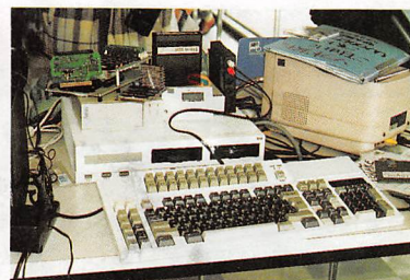
MSX2の皮をかぶったターボR。キーひとつでディスクがオートイジェクトするあやしい改造マシンだ
