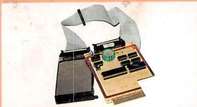
MSXの環境向上にはまずこれ! 必需品なだけに、赤字覚悟で提供させていただきます。これは、MSXにPC98ノートで使われているハードディスクバックをMSXに接続し、利用する為のカートリッジです。(容量制限、無し)他にも、DOS/V用HDDや、CD-ROMなどが接続可能です。フロッピーゲームをインストールして高速動作をさせたり、1Mを越える大容量ファイルを扱う事もできます。
