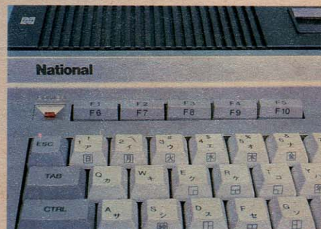
◆キーボード—鍵盤を押さえると文字が符号に変換する基本的な入力装置のこと。CF 2000はキータッチが軽い
