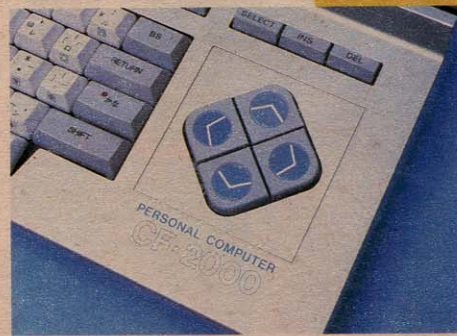
◆カーソルキー。カーソルとは、CRT画面上に表示される記号で、それを上下左右に移動させるのがカーソルキー
