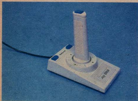
◆ジョイスティック—棒の操作で上下左右の座標値を変え、おもにゲームで使用。CF 2000は2個取付けが可能
