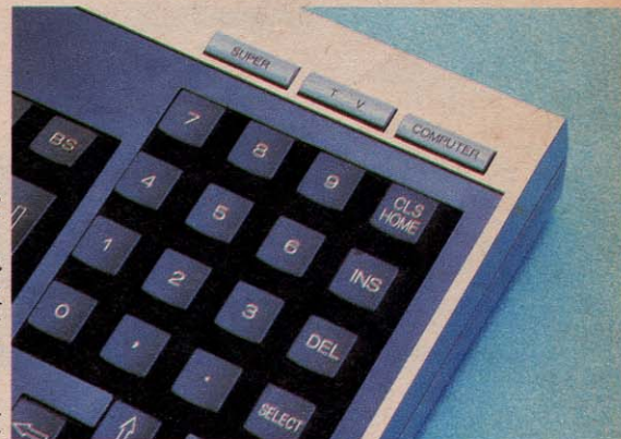
●キーボード右端のテンキーとモード切り換えスイッチ。テンキー部分にはカンマとピリオド(小数点)が付属する。モード切り換えスイッチはタッチタイプ。
