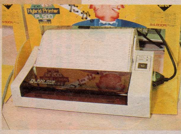
▲MSX対応のプリンタPL-500。オプションの漢字ROMボードで、漢字プリンタにヘンシ〜ン。文字の拡大、縮小や、カラーグラフィックスもスイスイこなす賢さです。
