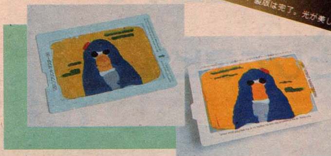
←製版された原画に各種のインクを塗りつけてゆく。1枚の原版に何色もの色をつけることも可能だ。色別に何枚もの原版を用意すれば、手間はふえるが、きれいな仕上がりを望むことができる。
