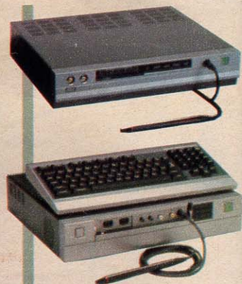
●①グラフィック拡張ユニット：MPC-X(サンヨー、価格未定)、②MSX：WAVY-11 MPC-11(サンヨー、¥99,800) / MPC-Xと、WAVY-11を組み合わせる。512×204ドットの高解像モードで、512色の中から任意の16色がドット単位で選択でき、また、画面一部を8倍までに拡大して描き込めるズーム機能、画面を四角に割り付けるウインドウ機能、8階調まで表現できるスチル機能が備わり、高いグラフィック能力を発揮する。サンヨーの拡張I/Oボックスを本体の拡張バスに接続して、使用する。
