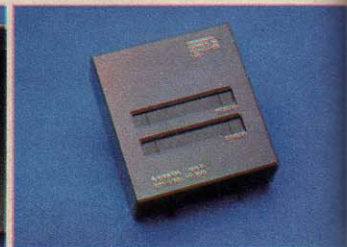
▲別売のI/Oボックス。拡張BASICカートリッジや各種ソフトを差し込む。
